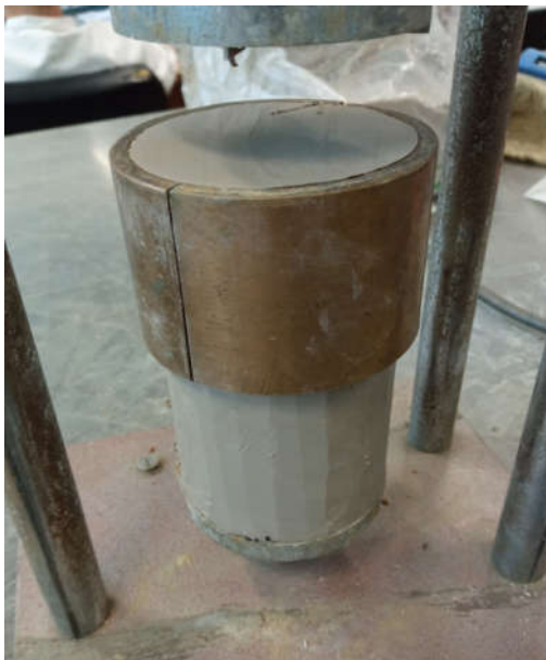
Slika 48.: Obrada uzorka za laboratorijsku krilnu sondu, (fotografirano uz dozvolu IGH, 2023.)
