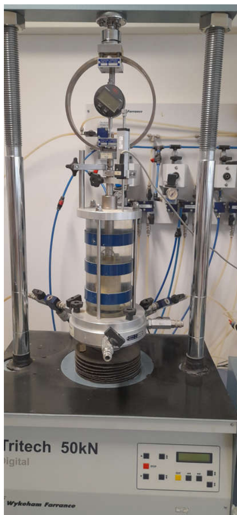
Slika 37.: Preša, troosna ćelija, prsten za mjerenje sile, mjerilo pomaka, (fotografirano uz dozvolu IGH, 2023.)
