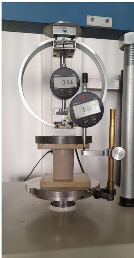
Slika 33.: Ispitivanje uzorka u preši, (fotografirano uz dozvolu IGH, 2023.)
