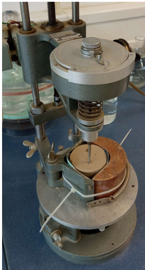
Slika 27.: Laboratorijska krilna sonda, (fotografirano uz dozvolu IGH, 2023.)
