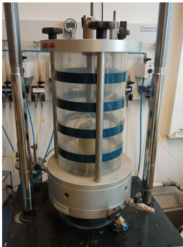
Slika 51.: Troosna ćelija korištena za pripremu uzorka za laboratorijsku krilnu sondu, (fotografirano uz dozvolu IGH, 2023.)
