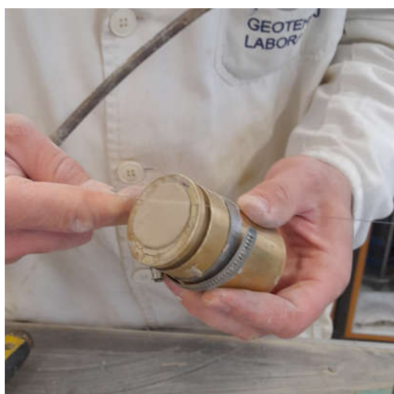
Slika 32.: Poravnanje ploha uzorka pomoću kalupa i žice, (fotografirano uz dozvolu IGH, 2023.)
