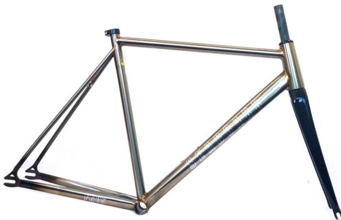
Slika 2.8 Prikaz jednobrzinskog okvira bicikla [67]
