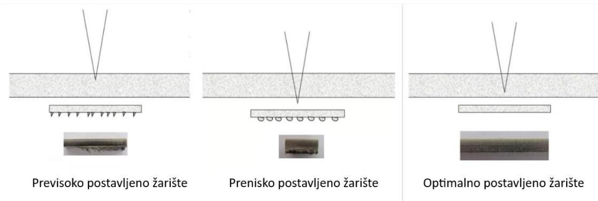
Slika 20: Utjecaj položaja žarišta na kvalitetu rezne površine [18]
