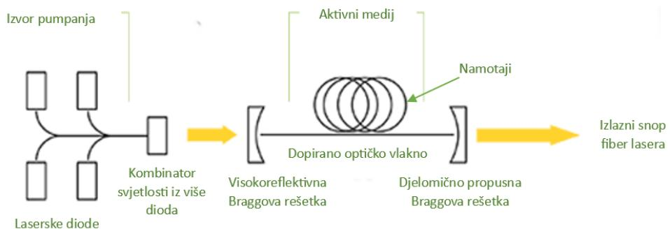
Slika 12: Shematski prikaz rezonatora fiber lasera [9]
