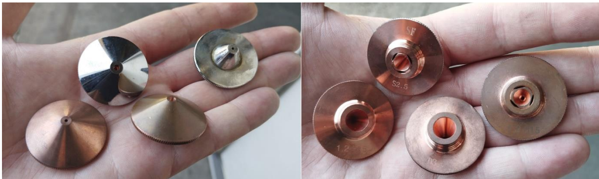
Slika 23: Sapnice različitih vrsta i promjera (Senfeng SF3015G)
