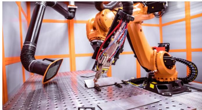
Slika 26: Robotski sustav za lasersko rezanje [26]
