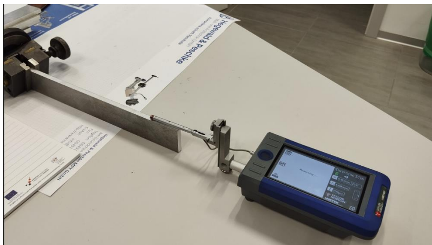
Slika 49: Postupak mjerenja hrapavosti površine
