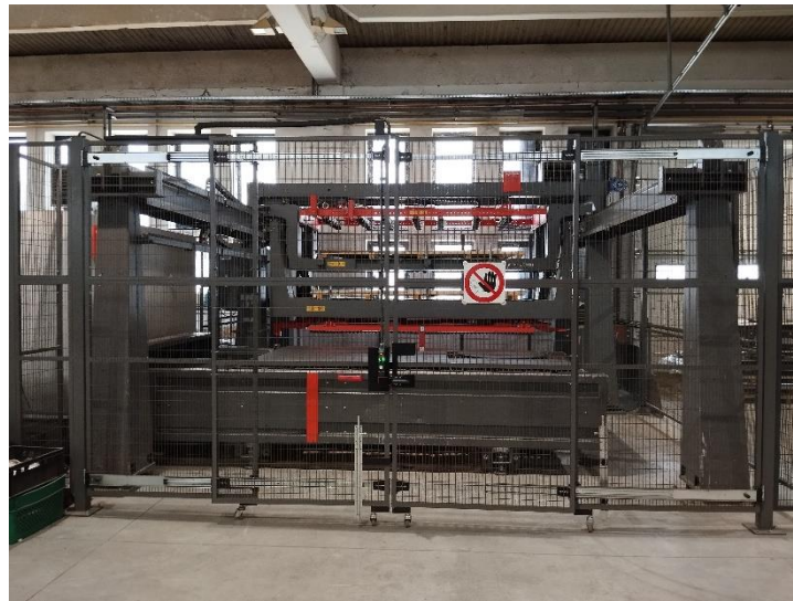
Slika 33: ByTrans Cross paletni sustav i drugi izmjenjivi radni stol
