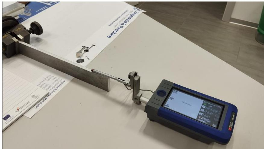
Slika 49: Postupak mjerena hrapavosti površine
