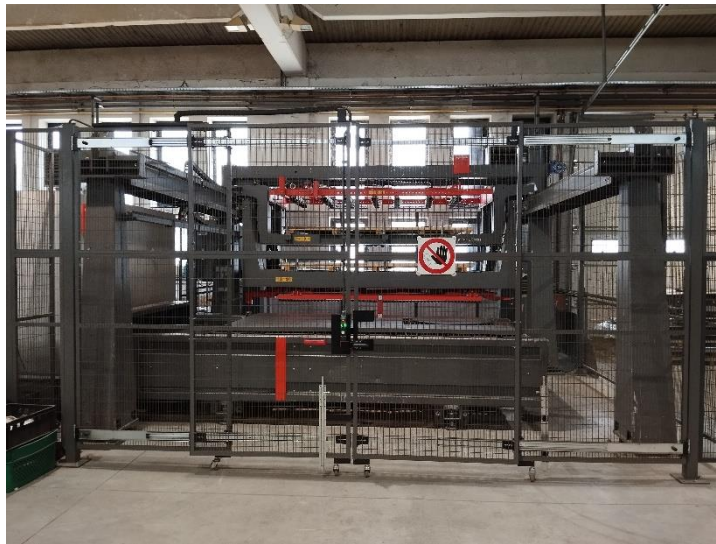
Slika 33: ByTrans Cross paletni sustav i drugi izmjenjivi radni stol
