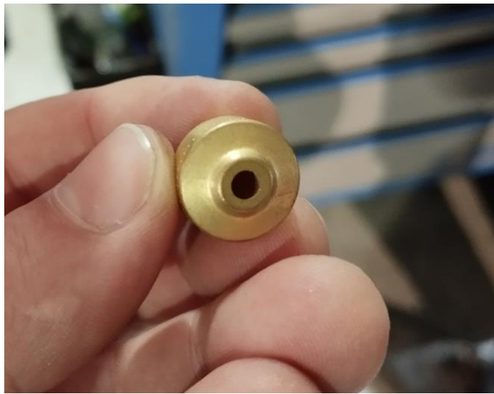
Slika 22: Primjer sapnice (Bystronic Bystar Fiber 3015)
