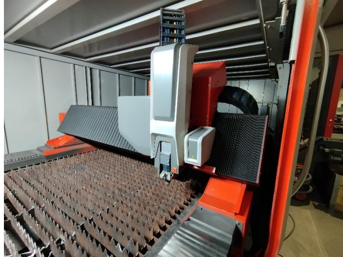
Slika 32: Radni prostor i radna glava stroja
