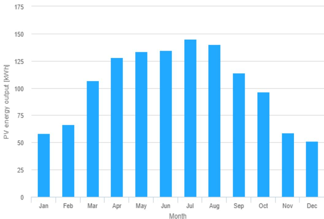
*Slika 6.3. Mjesečne vrijednosti izlazne energije fotonaponskog sustava [21]*
