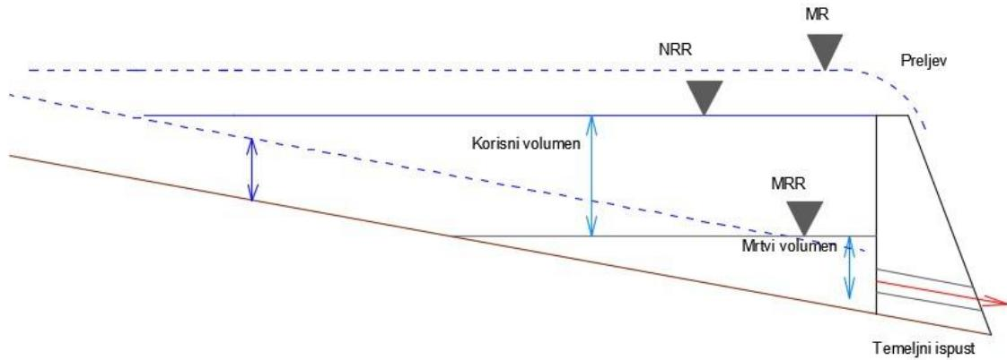
*Slika 2.1 Shematski prikaz osnovnih parametara akumulacije [6]*
