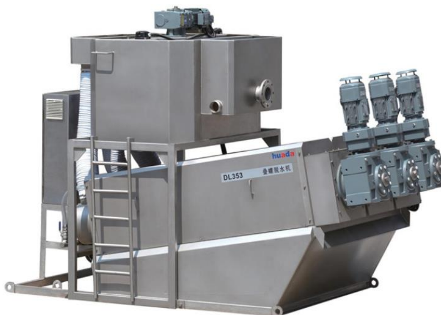
Slika 30. Pužni dehidrator mulja [35]
