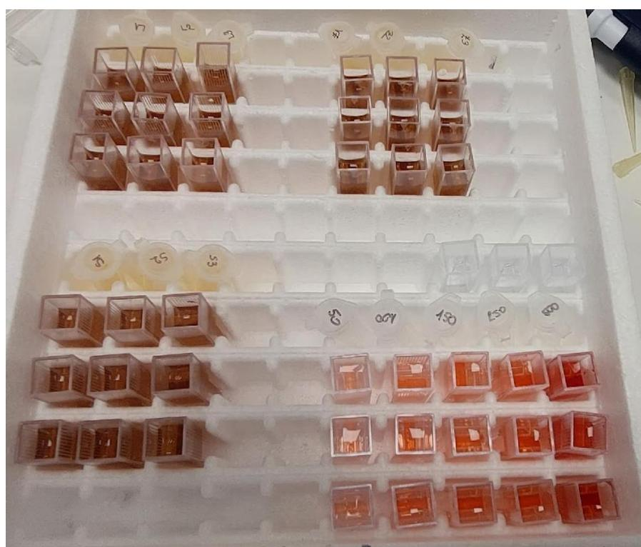
*Slika 9: Prikaz mjerjenja ukupnih flavonoida u ekstraktima lista ginka te u standardnoj otopini katehina*
