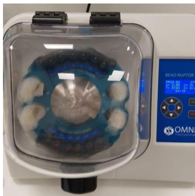
Kuglični mlin Bead Ruptor 12, Omni International Sjedinjene Američke Države
