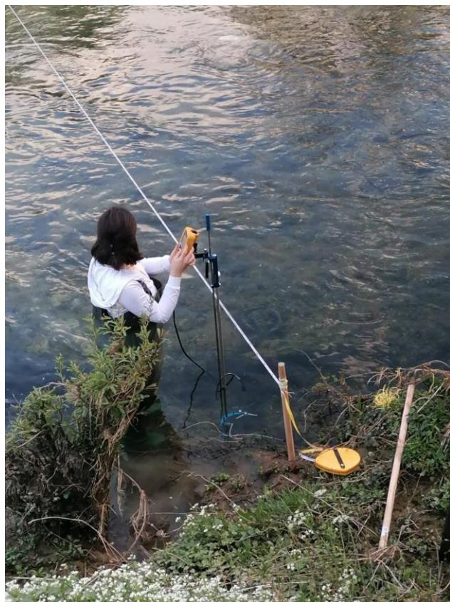
Slika 16. Postupak mjerena Flow Tracker2 ultrazvučnim uređajem [8]
