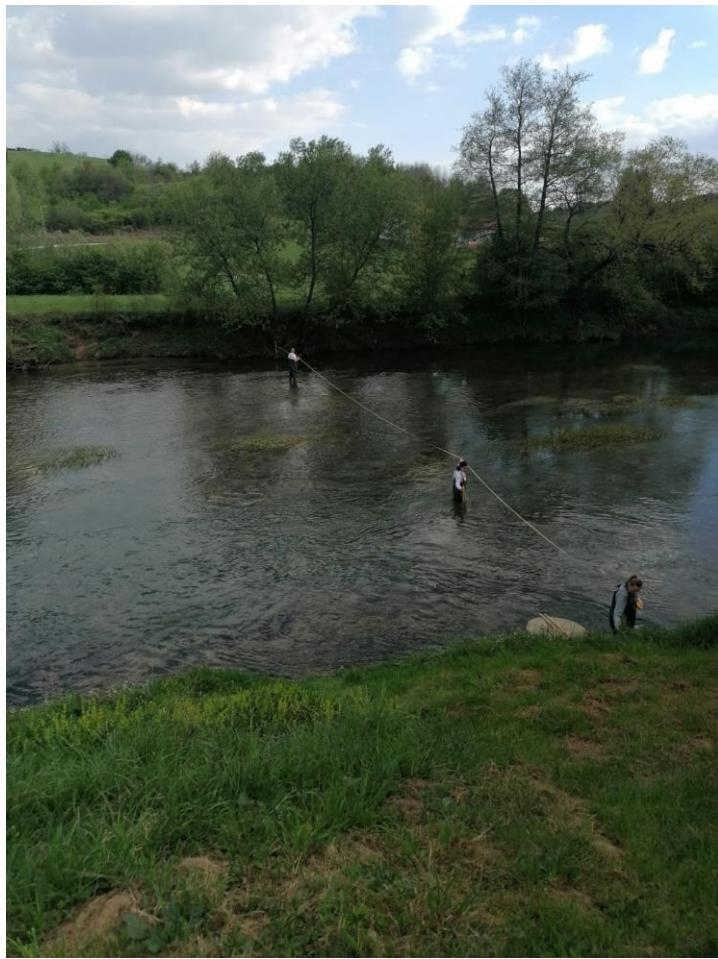
Slika 15. Postavljanje mjerne trake na profilu rijeke Dobre [8]
