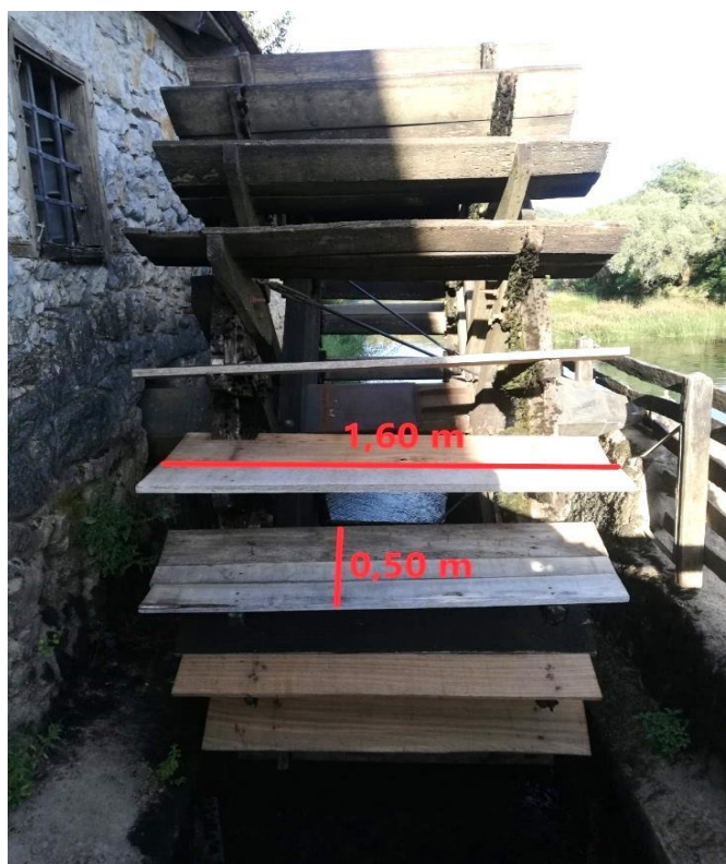
Slika 44. Lopatice mlinskog kola [13]
