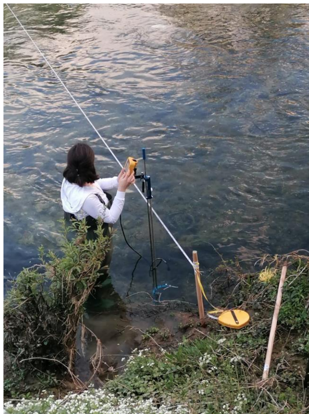
Slika 16. Postupak mjerenja Flow Tracker2 ultrazvučnim uređajem [8]
