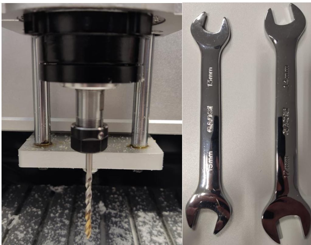
Slika 33. Stegnuto svrdlo i viličasti ključevi za stezanje svrdla
