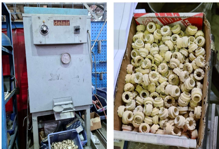
Slika 3.5. Prikaz peći za sušenje elektroda i keramičkih prstenova (lijevo) te osušenih keramičkih prstenova (desno)
