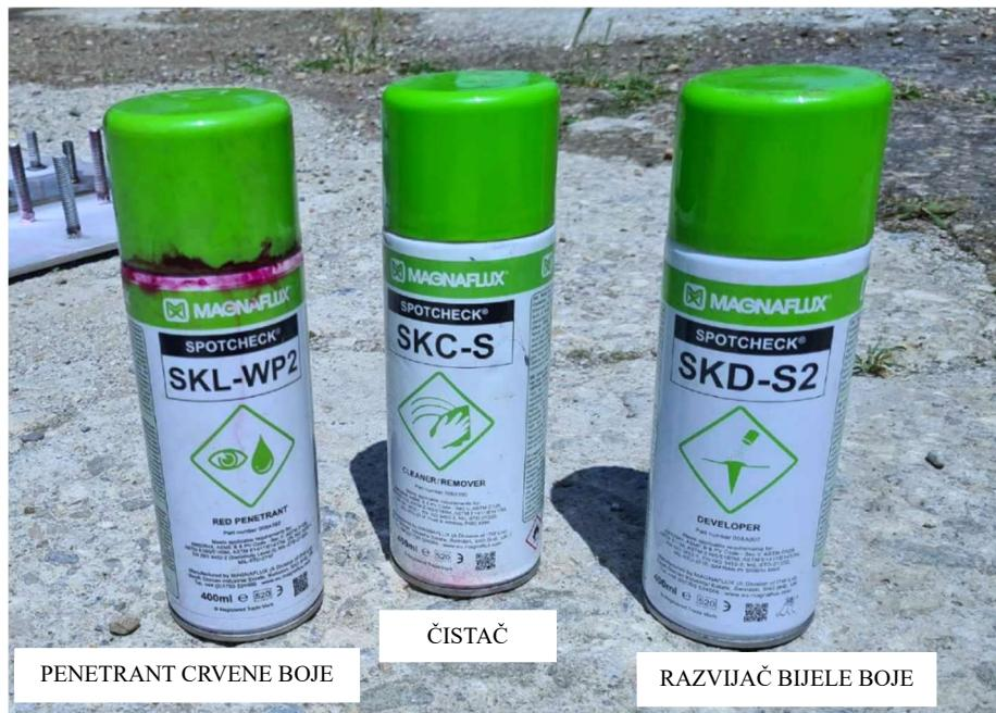
*Slika 4.34. Sredstva penetracijske metode ispitivanja*
