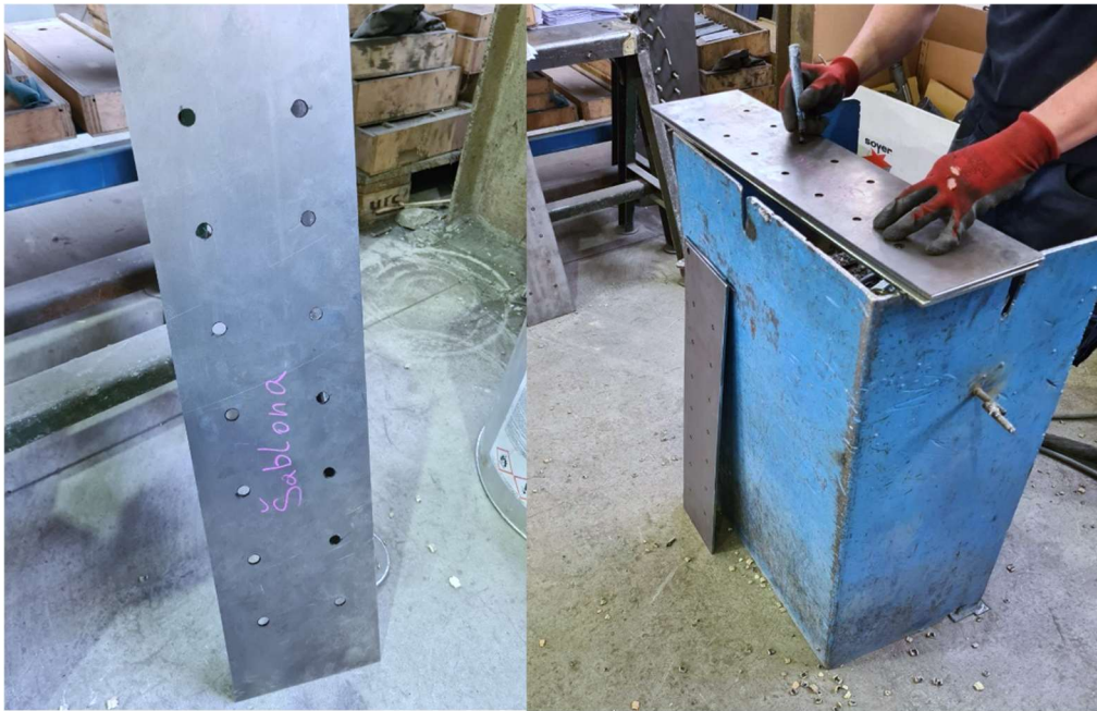
Slika 4.10. Šablona za ocrtavanje pozicija svornjaka (lijevo) i postupak ocrtavanja pozicija na ispitnoj ploči (desno)
