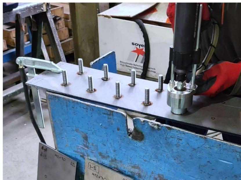
*Slika 3.9. Postavljanje pištolja zavarivanja u poziciju zavarivanja*
