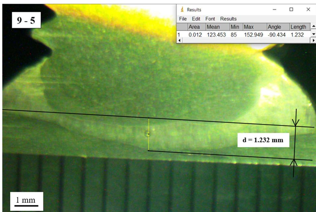
Slika 4.29. Mjerenje penetracije zavara makro izbruska uzorka 9-5
