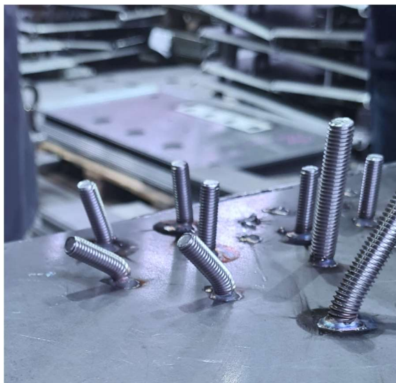
Slika 2.6. Ispitivanje savijanjem pod kutom od 60 stupnjeva u praktičnom primjeru
