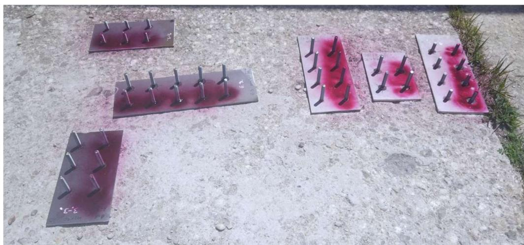
*Slika 4.35. Naneseni crveni penetrant na ispitne ploče*
