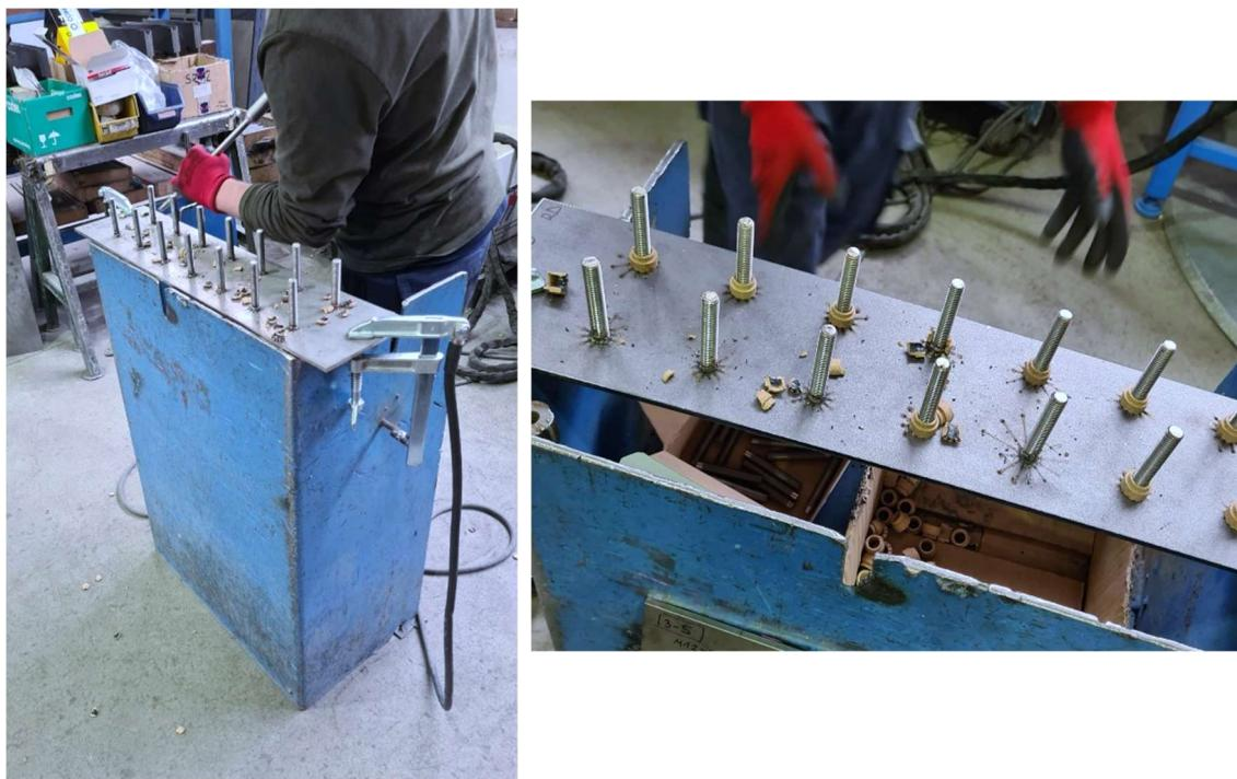
*Slika 4.12. Mehaničko čišćenje i uklanjanje keramičkih prstenova nakon završenog zavarivanja*
