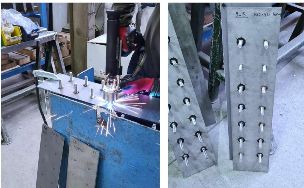
Slika 4.14. Tijek SRM postupka zavarivanja (lijevo) te izgled zavarenih ispitnih ploča (desno)
