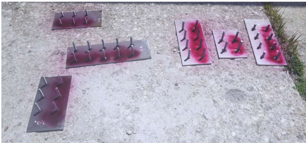
Slika 4.35. Naneseni crveni penetrant na ispitne ploče
