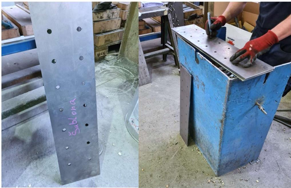
*Slika 4.10. Šablon za ocrtavanje pozicija svornjaka (lijevo) i postupak ocrtavanja pozicija na ispitnoj ploči (desno)*
