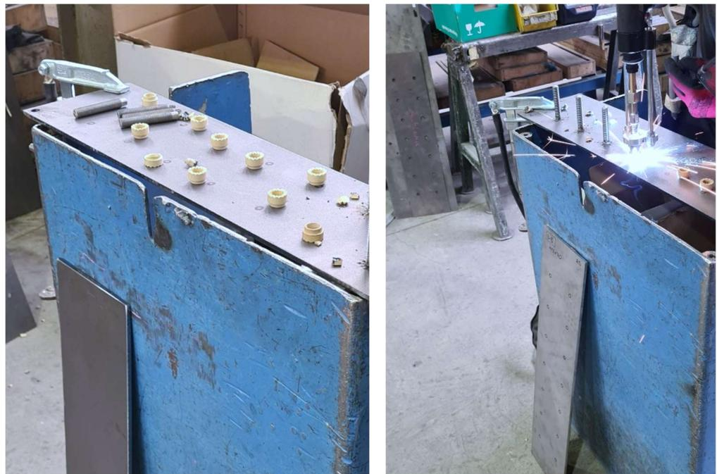
*Slika 4.11. Priprema svornjaka i pripadajućih keramičkih prstenova za zavarivanje (lijevo) i tijek elektrolučnog zavarivanja svornjaka s keramičkim prstenovima (desno)*
