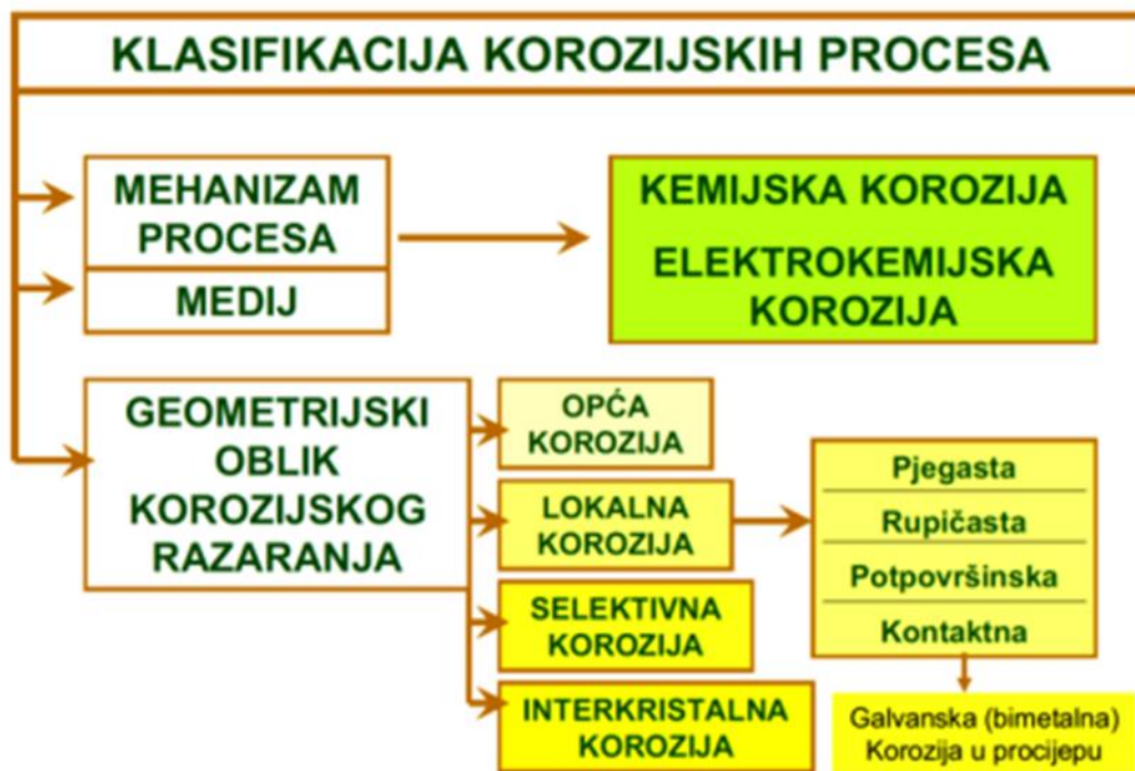
Slika 5 Klasifikacija korozijskih procesa [9]
