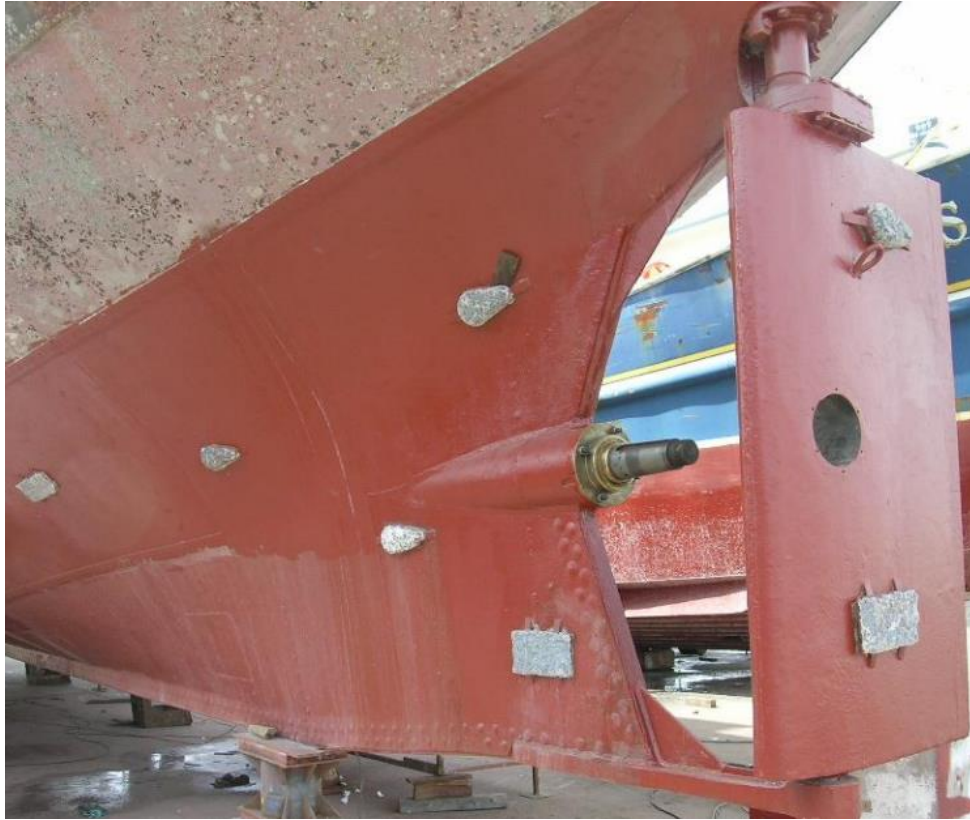
Slika 31 Zaštita brodskog trupa protektorskim anodama od cinka [13]
