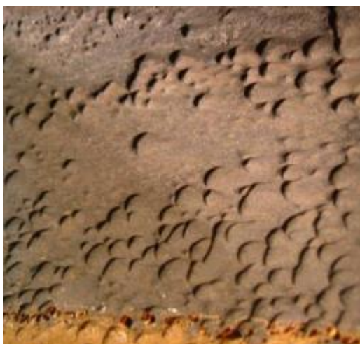
Slika 16 Udarni napad u obliku kopita [10]
