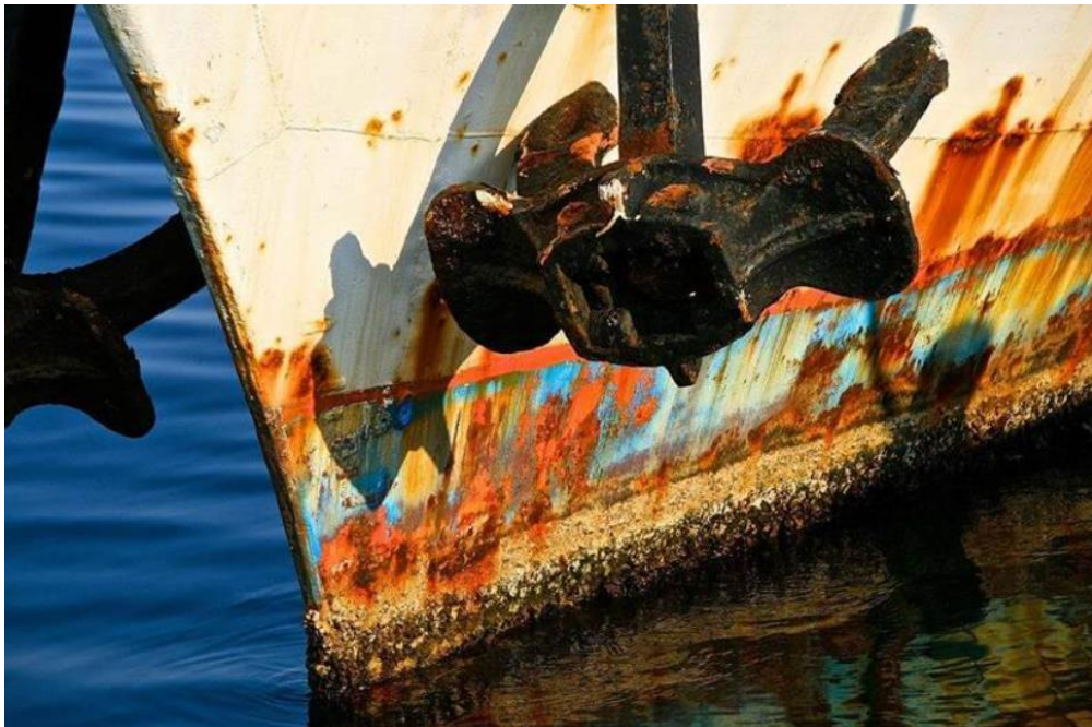
Slika 1 Korozija trupa broda [1]
