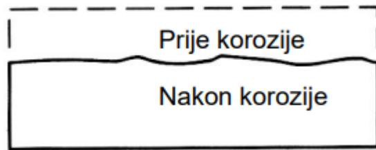
Slika 6 Shematski prikaz površine materijala zahvaćenog općom korozijom [10]
