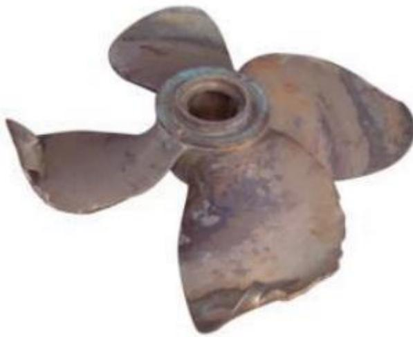
Slika 18 Kavitacijska korozija brodskog propelera [4]
