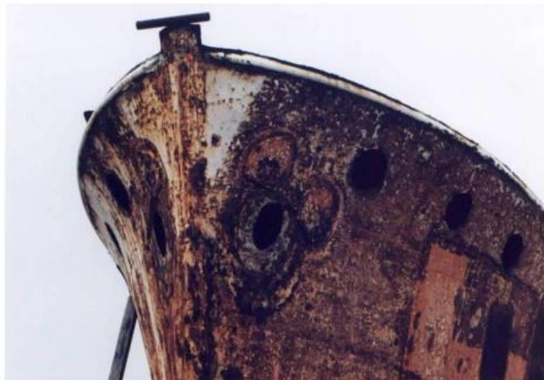
Slika 7 Opća korozija na čeličnoj oplati trupa broda [10]
