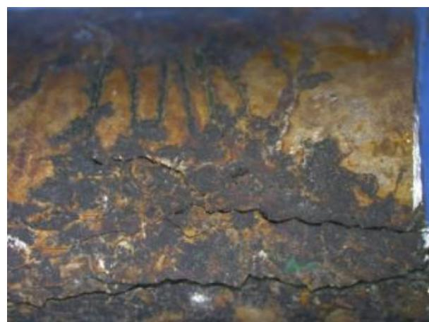
Slika 13 Transkristalna napetosna korozija [10]
