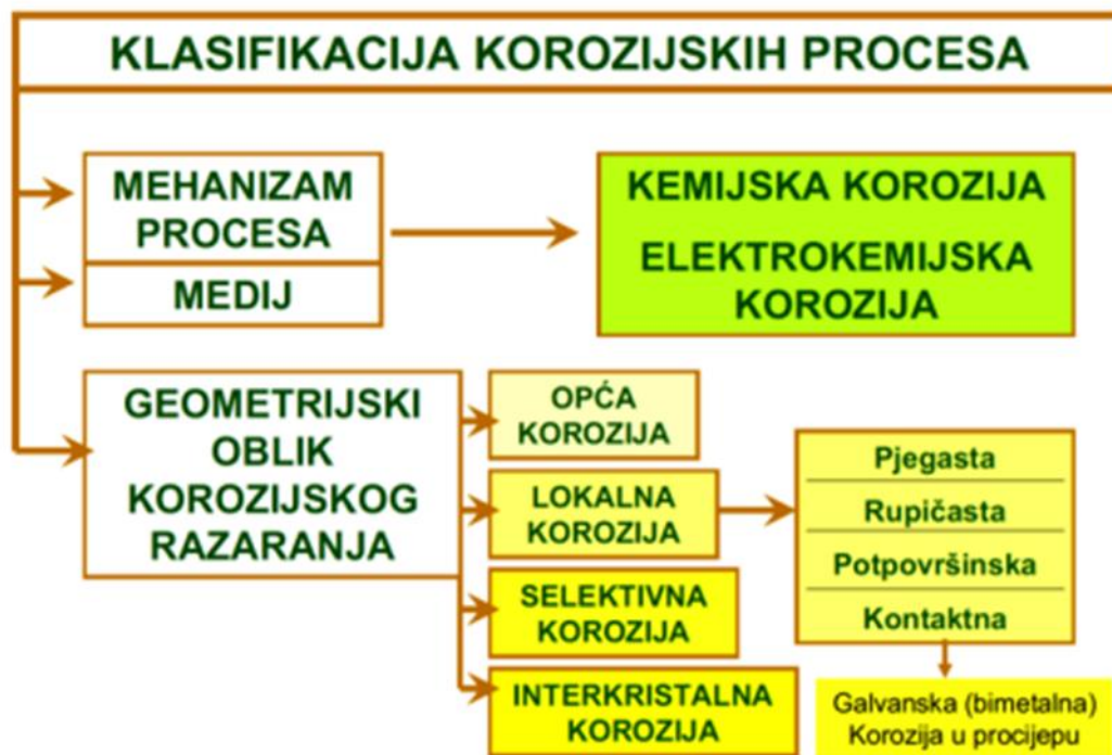
Slika 5 Klasifikacija korozijskih procesa [9]
