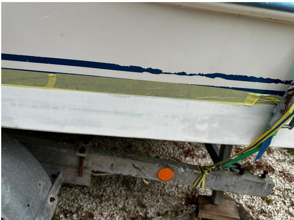
Slika 26 Svježe nanesen protuobraštajni premaz na plovilo [2]
