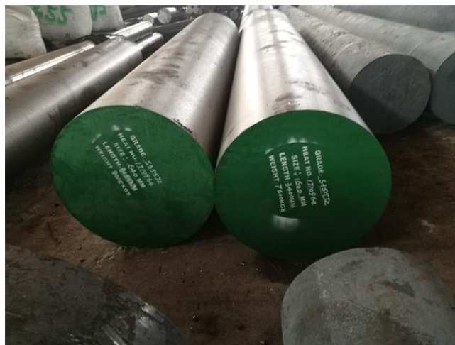
Slika 10 Čelik S355J2 + N u šipkastom obliku [11]
