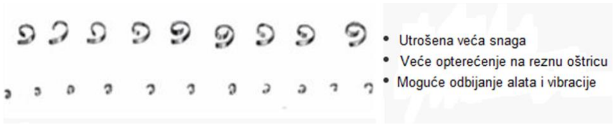
Slika 18 - Vrlo kratka i tanka odvojena čestica [15]
