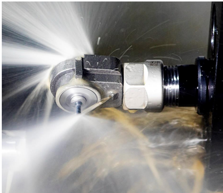
Slika 29 - Vreteno pokretano emulzijom [31]
