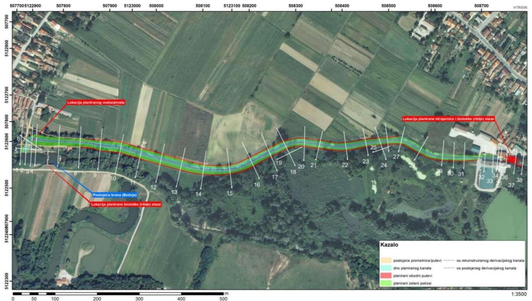
Slika 5.2.28. Derivacijski kanal - planirana rekonstrukcija kanala [8]
