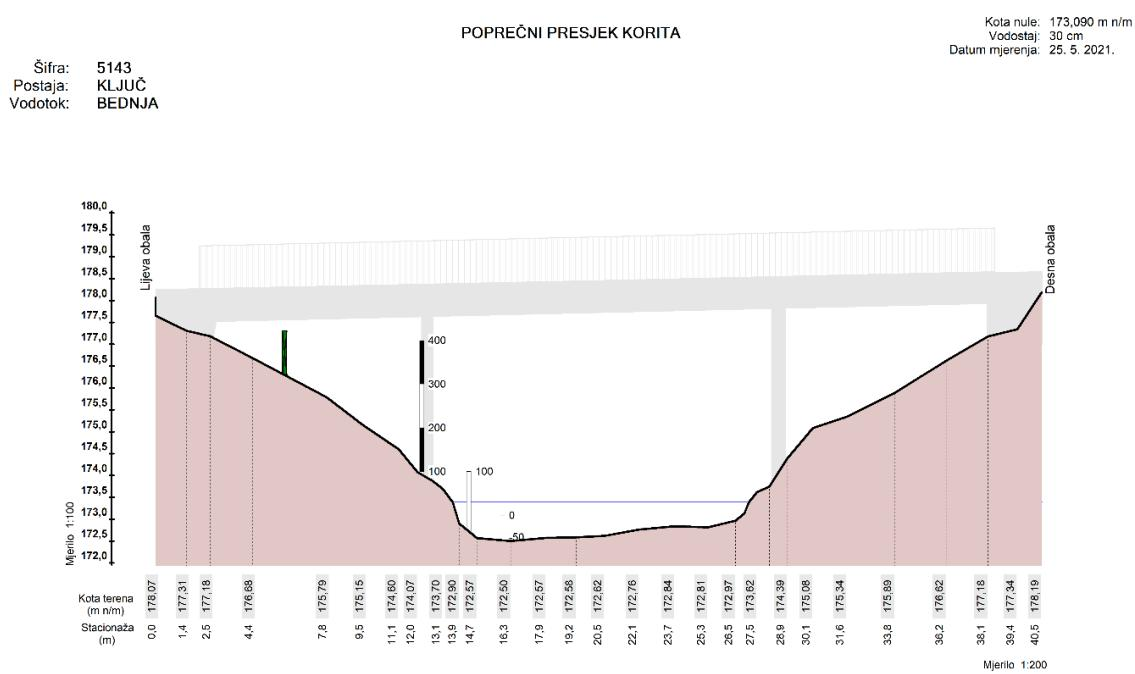
Slika 3.3.2. Poprečni presjek korita hidrološke stanice Ključ [6]
