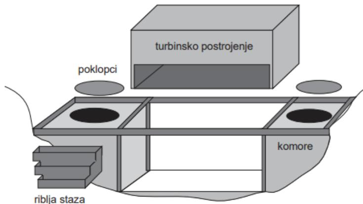
*Slika 5.2.27. Prikaz sastavnih dijelova mini hidroelektrane Ludbreg [10]*
