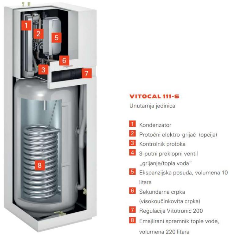
Slika 25. Prikaz unutarnje jedinice VIESMMAN Vitocal 111-S [9]
