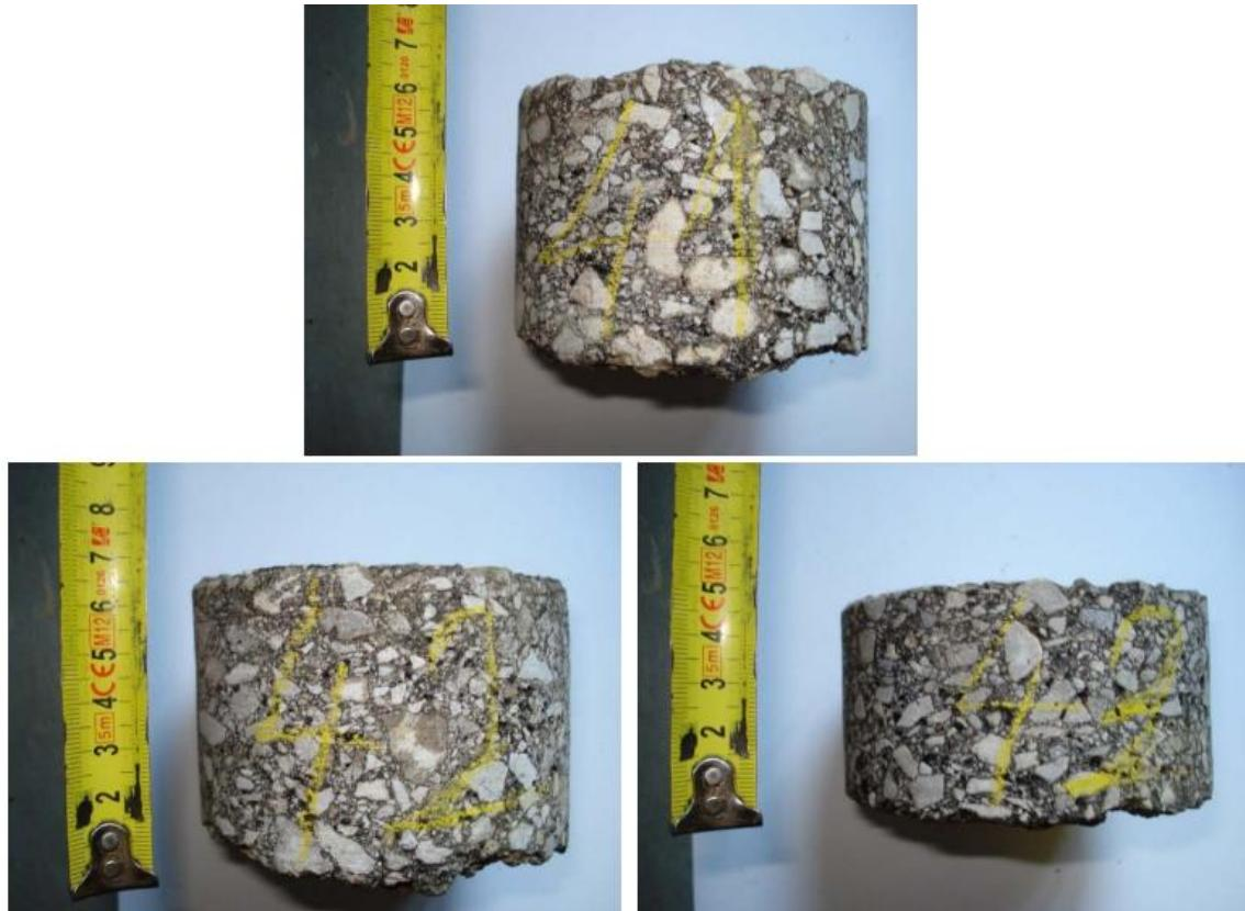
Slika 7. Ispitivanje debljine nosivog sloja (LC 34059)
