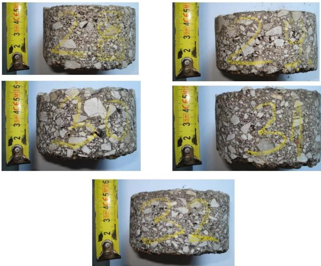
Slika 24. Ispitivanje debljine nosivog sloja (ŽC 3176)
