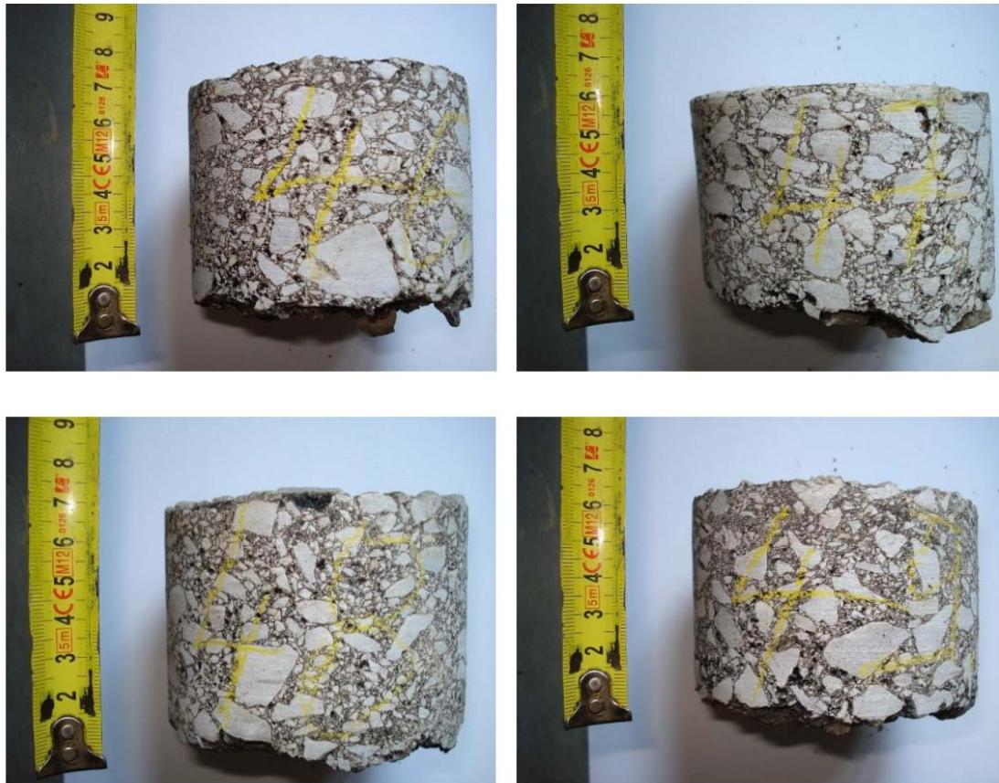
Slika 13. Ispitivanje debljine nosivog sloja (ŽC 3143)
