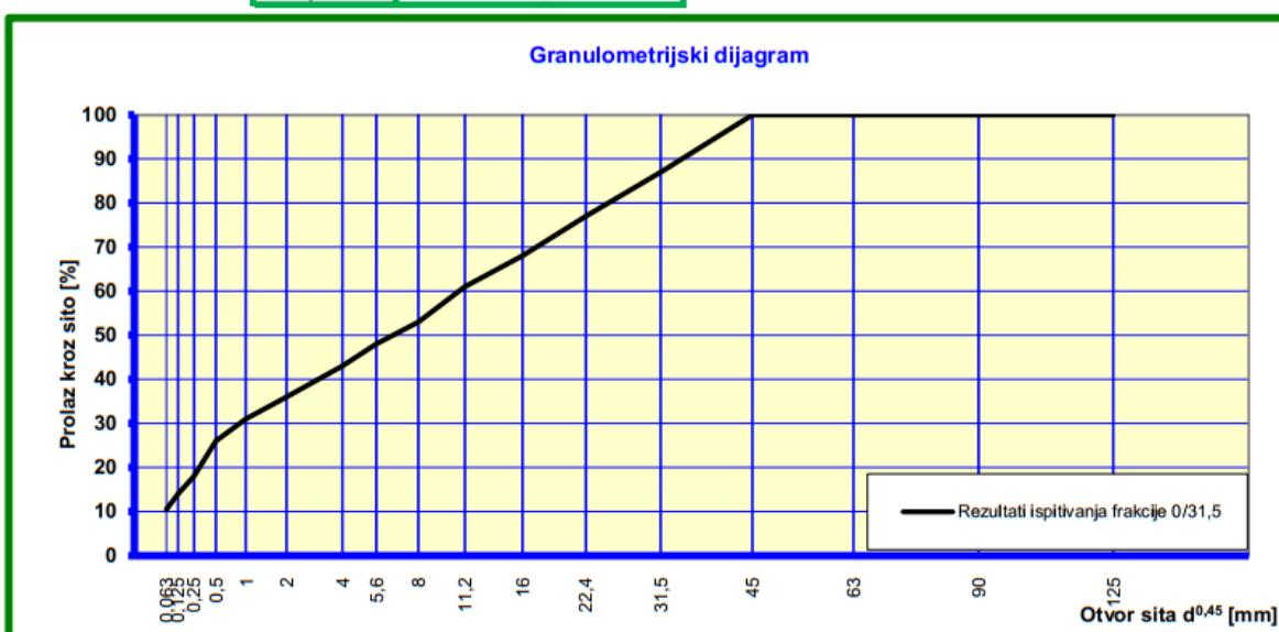
Prilog 4. Rezultati ispitivanja granulometrijskog sastava uzorka tampona (ŽC 3143)
