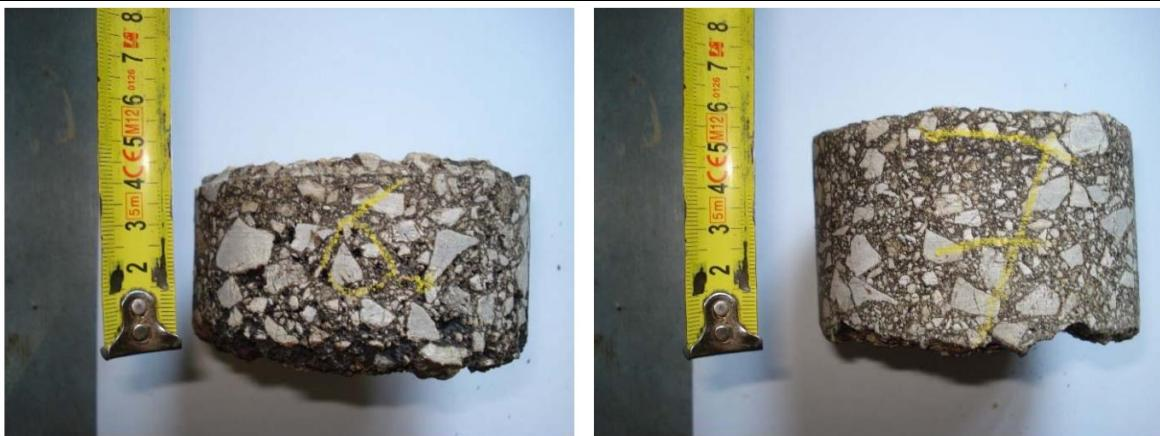
Slika 19. Ispitivanje debljine nosivog sloja (ŽC 3257)
