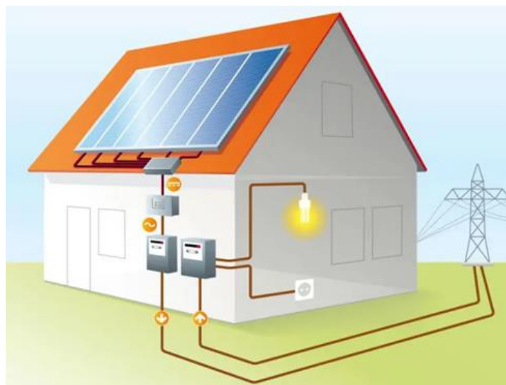
Slika 2.4. FN sustav izravno priključen na distribucijsku mrežu [4]
