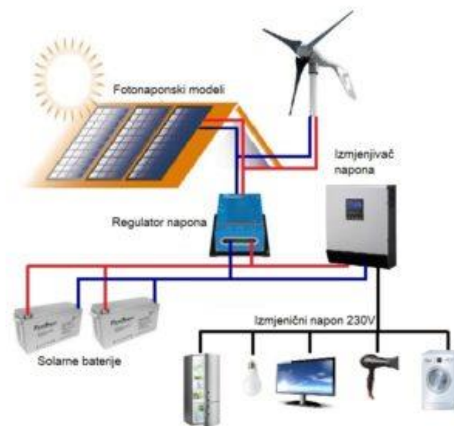
Slika 2.3. Hibridni sustav sa vjetrogeneratorom [4]
