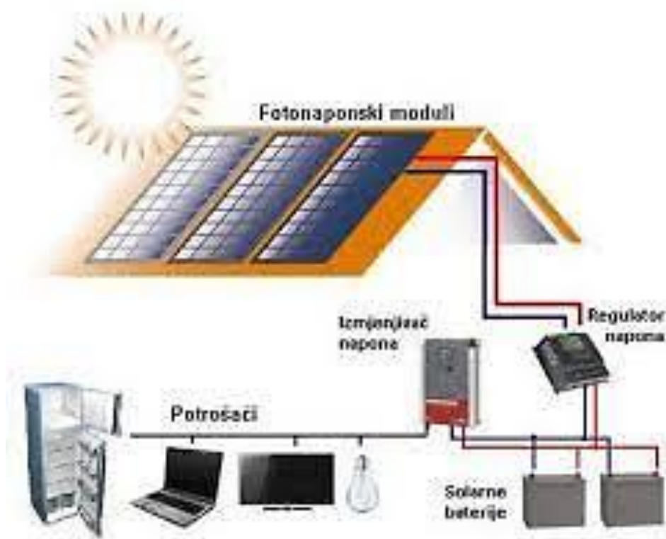
Slika 2.2. Samostalni sustav s pohranom [4]
