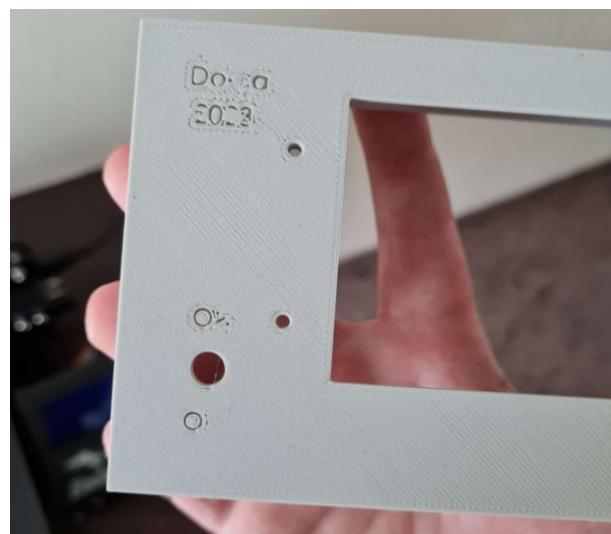
Slika 6.2. – prednji dio kućišta, isprintan
