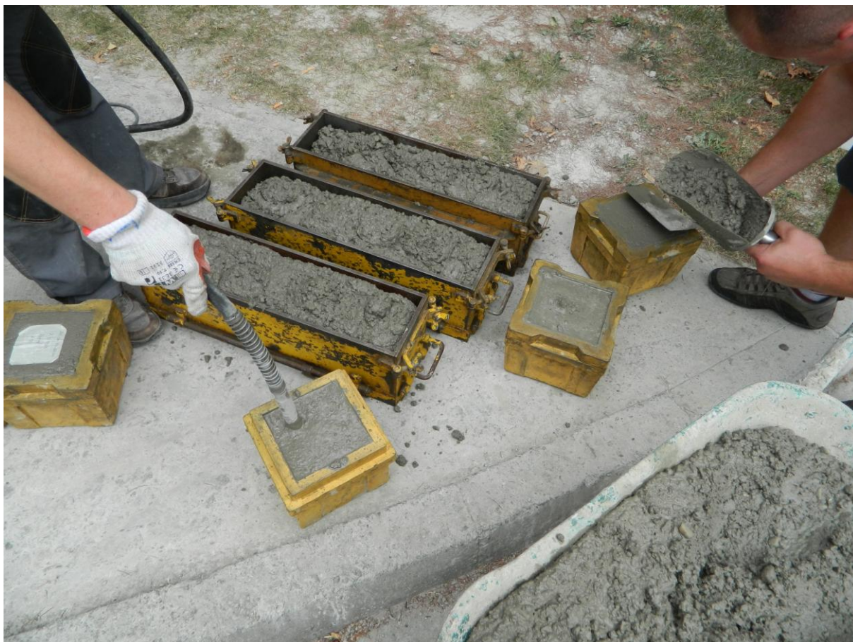
Slika 21 Betoniranje modela betonskih prizmi
