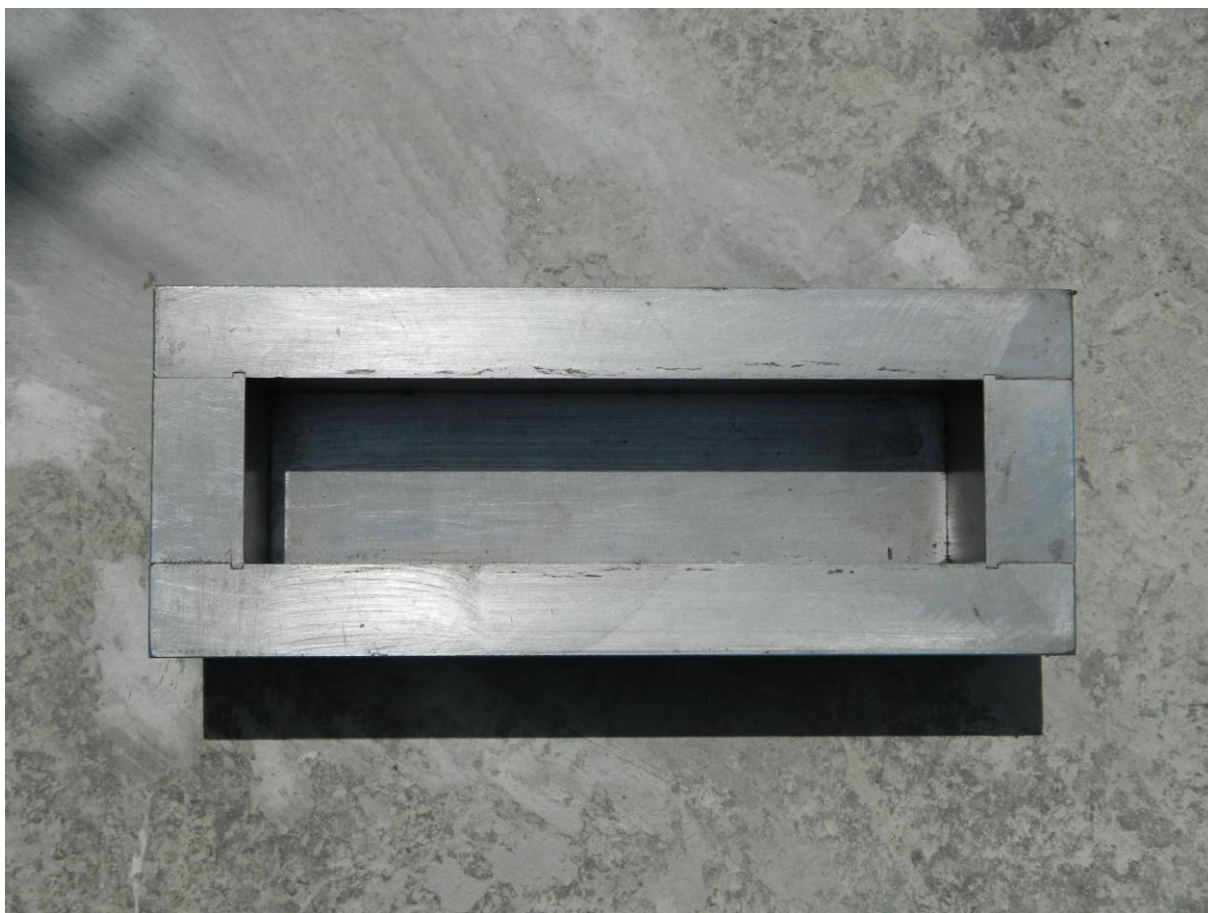
Slika 20 Kalup za betoniranje betonskih prizmi
