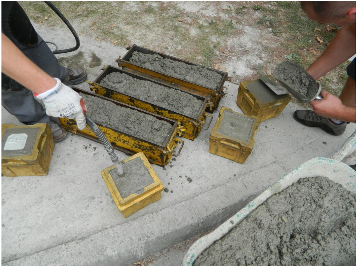
Slika 21 Betoniranje modela betonskih prizmi
