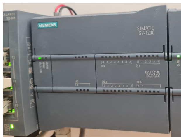
Slika 2.4: Korišteni PLC S7-1200
