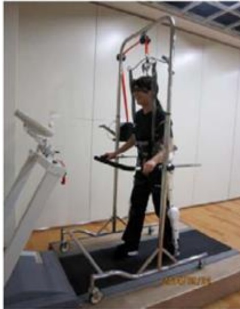
Slika 3.8. Hodanje na traci za trčanje uz asistenciju robota, Izvor: [51]
