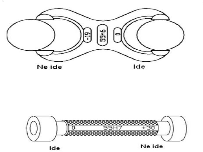
Slika 37. Kalibri za unutarnje i vanjske mjere
