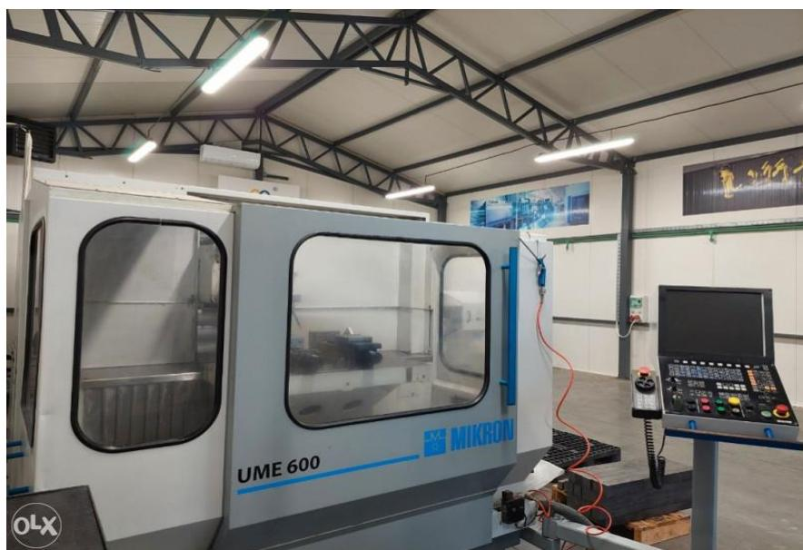
Slika 22. CNC Micron glodalica
