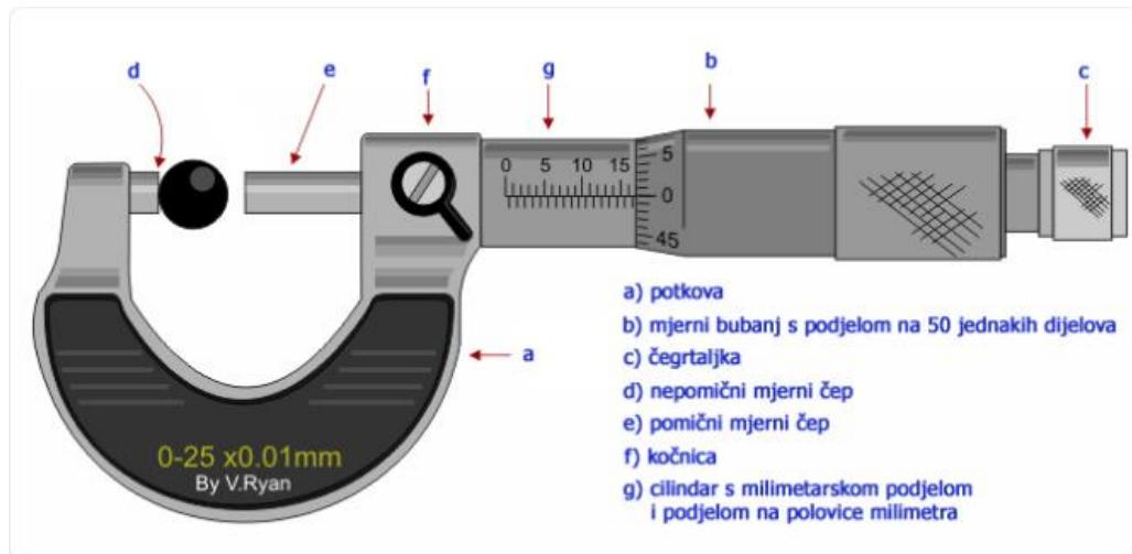
Slika 34. Mikrometar
