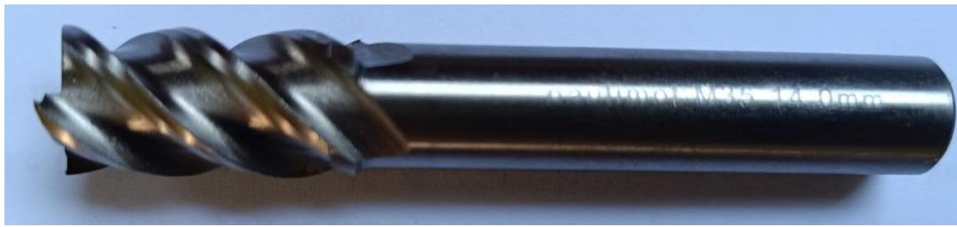
Slika 3. Glodalo od brzoreznog čelika
