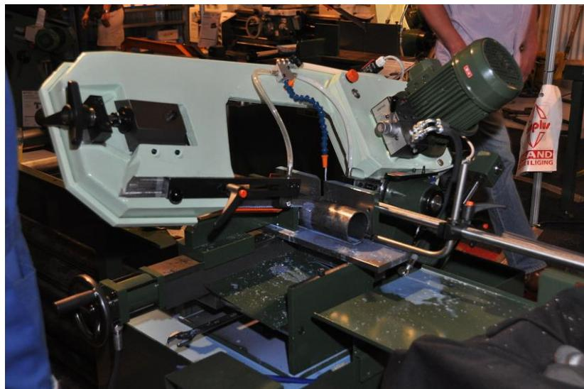
Slika 16. Vodoravna tračna pila
