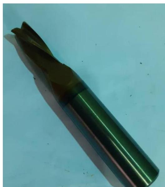
Slika 4. Tvrdometalno glodalo za finu obradu
