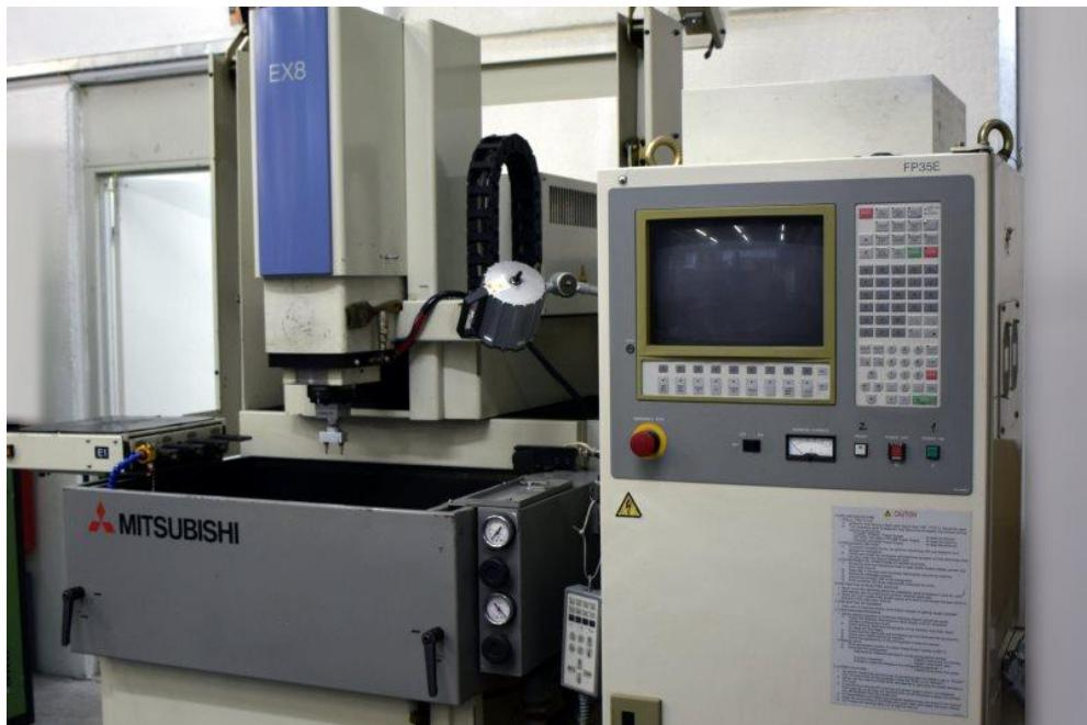
*Slika 25. Stroj za graviranje pomoću erozije (TM Čakovec)*
