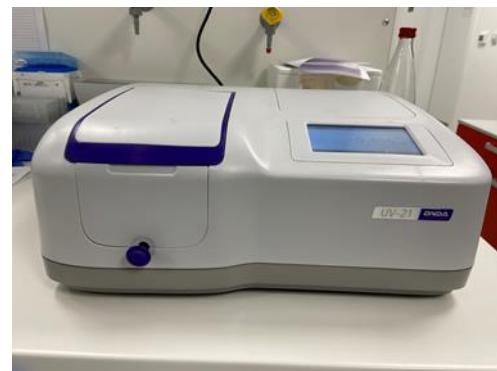
Spektrofotometar (ONDA UV-21, Kina)
