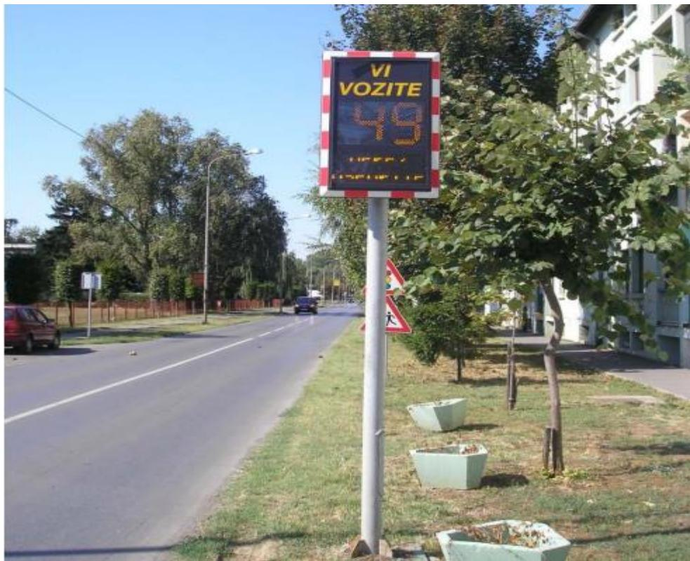
Slika 3-14 - Smirivanje prometa uređajem za određivanje brzine vožnje
