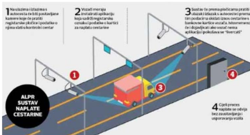
Slika 3-23 Automatski sustav prepoznavanja registracije
