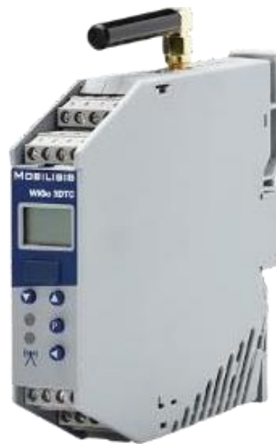
Slika 20: 3DTC brojač prometa
