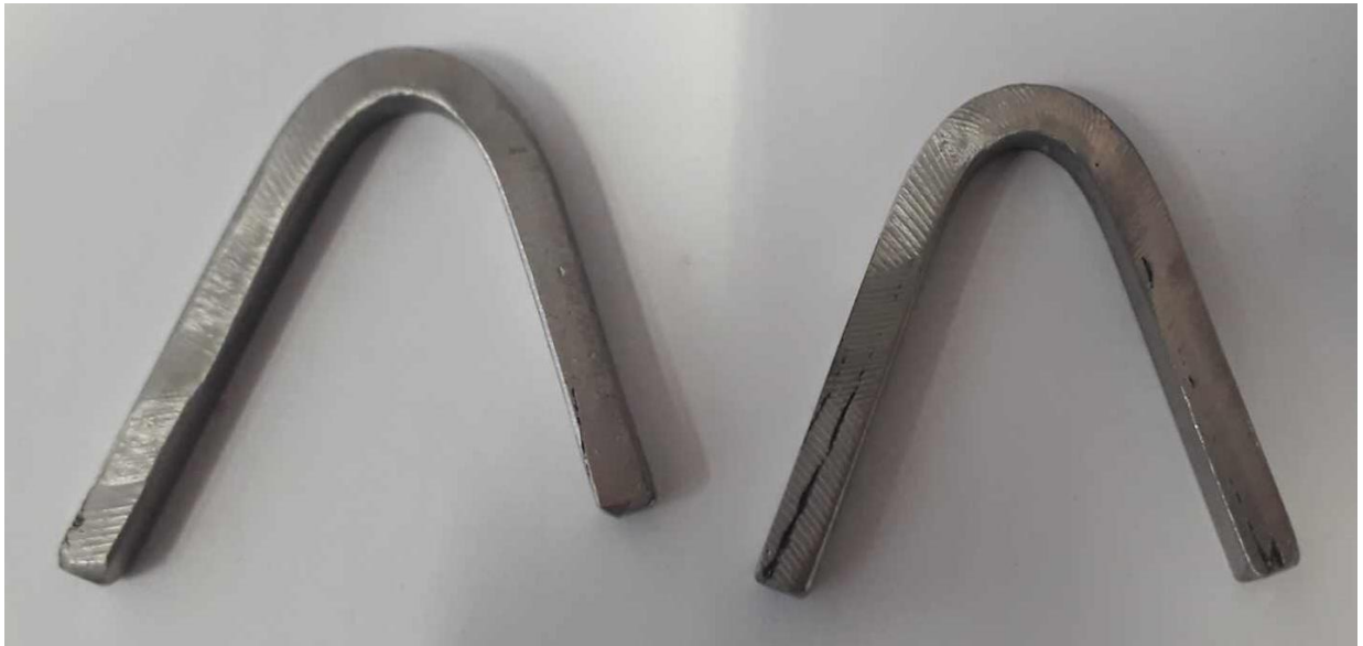
Slika 58. Uzorci navareni strujom jakosti 150 A nakon provedenog ispitivanja
