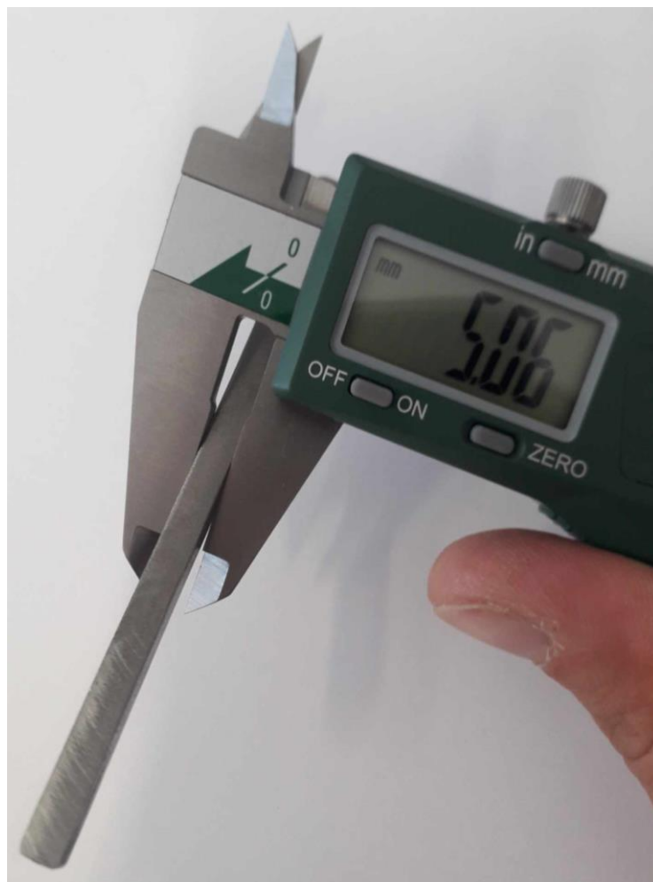
Slika 55. Dimenzije poprečnog presjeka ispitnog uzorka
