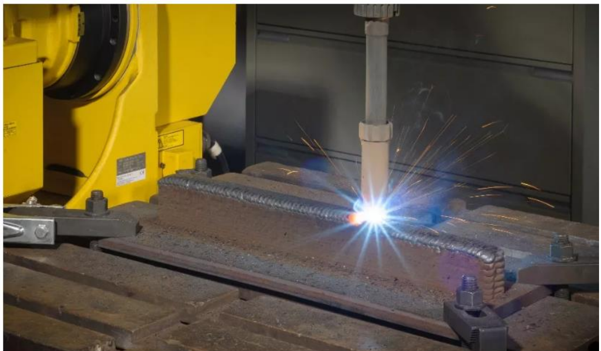
Slika 2. Proces aditivne proizvodnje metalne komponente [10]
