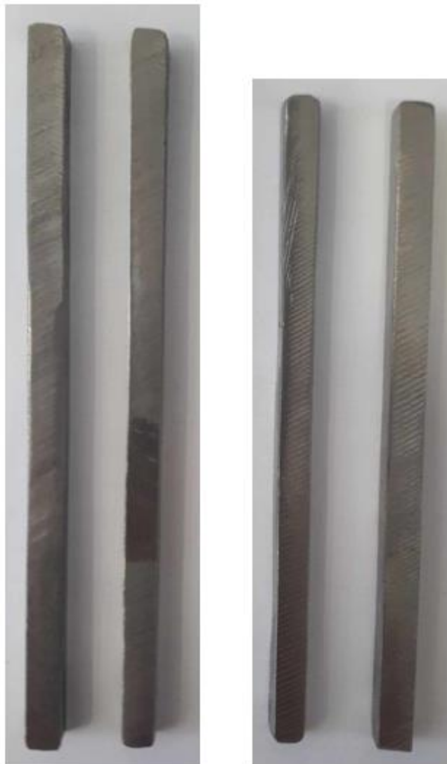
Slika 44. Ispitni uzorak za analizu makrostrukture tijekom faze grubog brušenja
