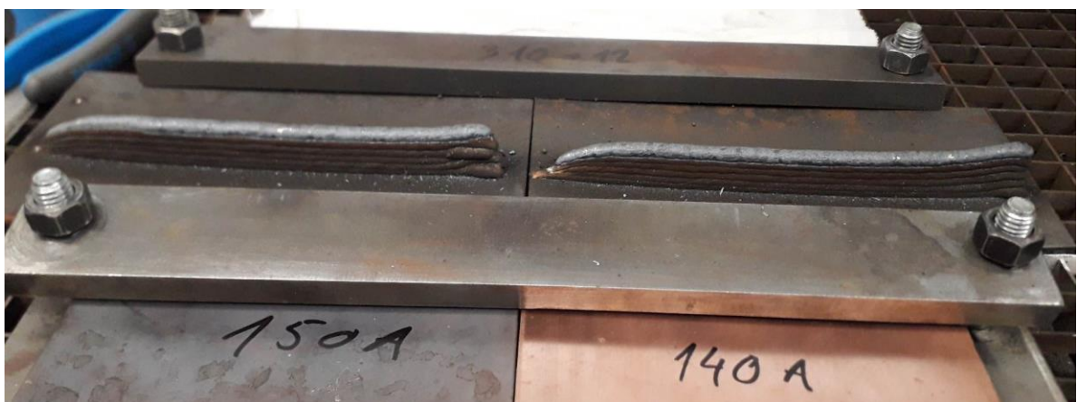
Slika 36. Uzorci zidova sa šest navarenih slojeva
