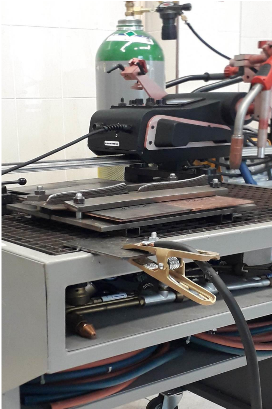
Slika 31. Radni prostor pri navarivanju uzoraka
