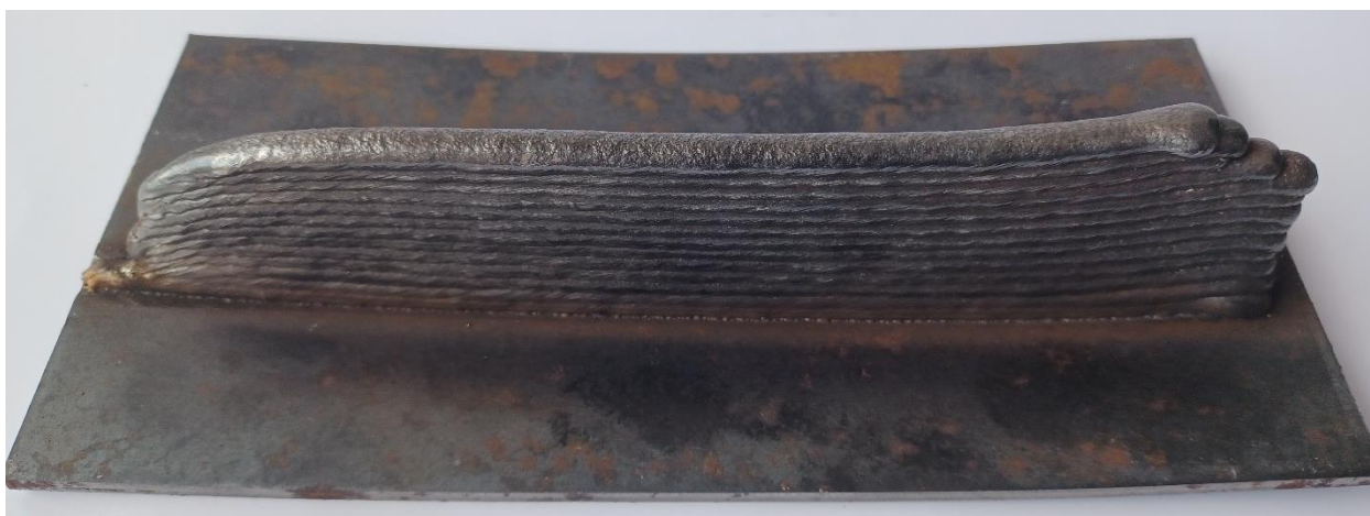
Slika 42. Ohlađen uzorak zida navaren strujom jakosti 140 A
