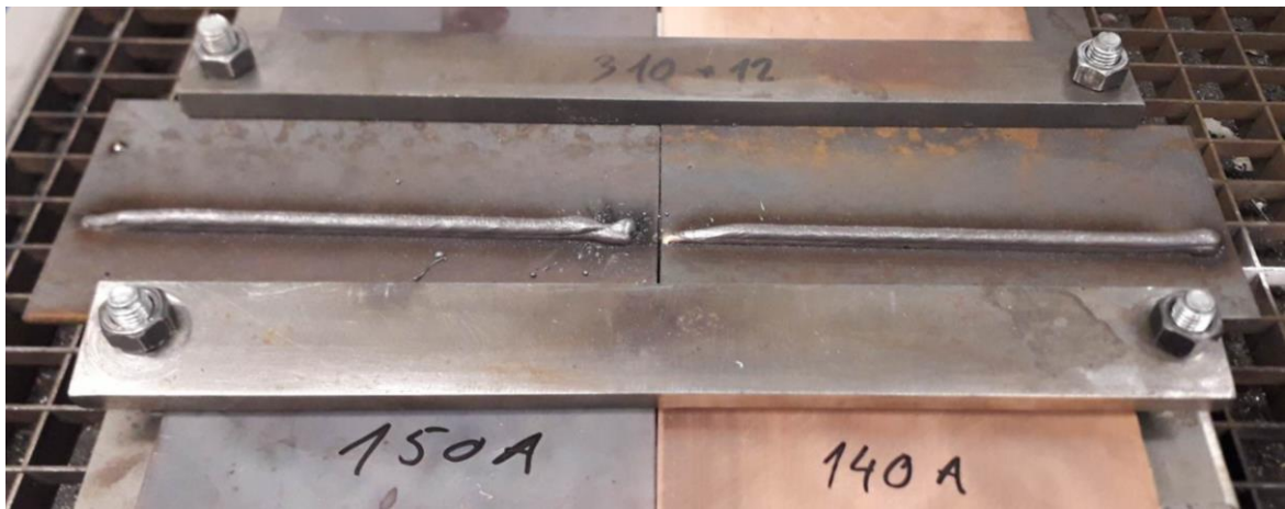
Slika 34. Uzorci zidova s dva navarena sloja
