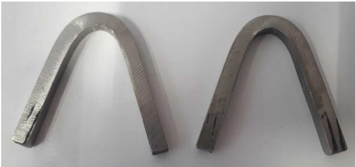
Slika 57. Uzorci navareni strujom jakosti 140 A nakon provedenog ispitivanja
