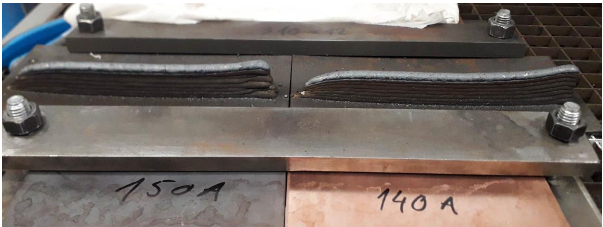
Slika 37. Uzorci zidova s osam navarenih slojeva
