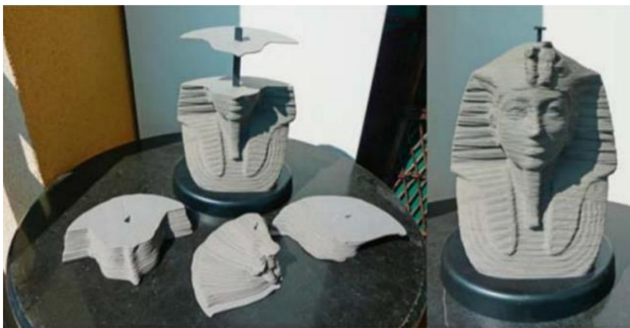
Slika 1. Faze nastanka elementa primjenom procesa aditivne proizvodnje [7]
