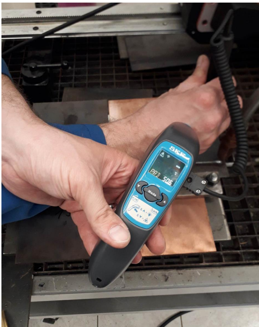
Slika 40. Mjerenje međuprolazne temperature pojedinih prolaza
