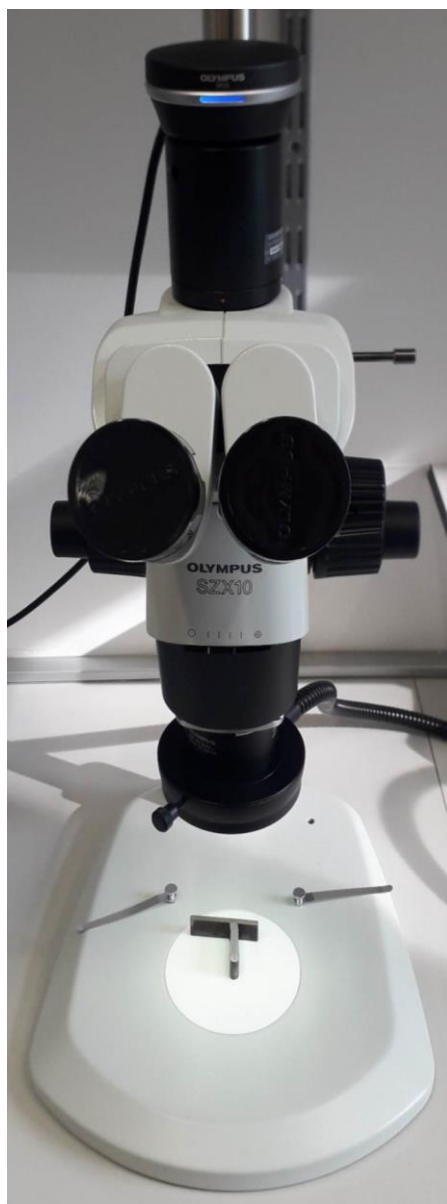
Slika 50. Proces analize makrostrukture ispitog uzorka
