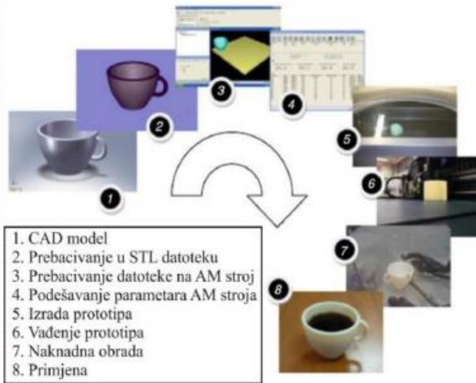
Slika 3. Faze izrade elementa procesom aditivne proizvodnje [6, 7]
