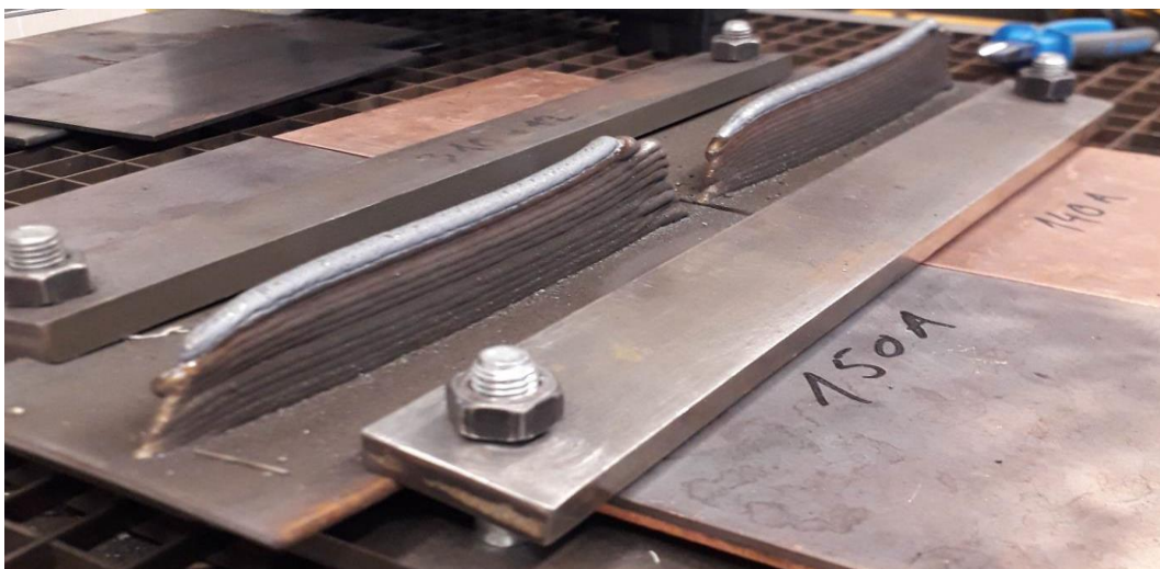
Slika 39. Uzorci zidova s 13 navarenih slojeva
