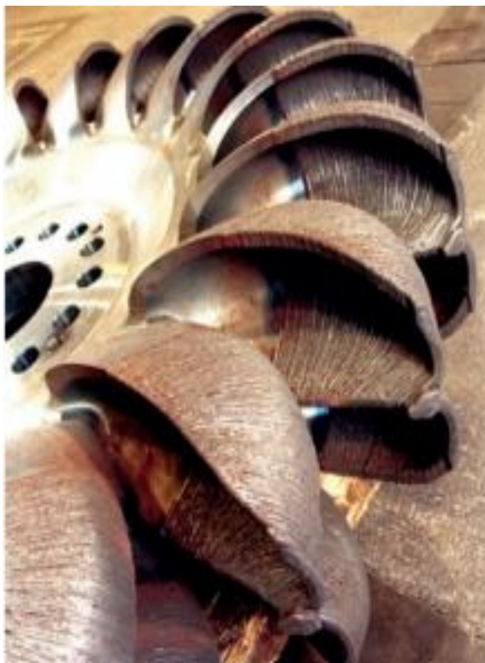
Slika 15. Lopatice vodene turbine izrađene WAAM postupkom [36]
