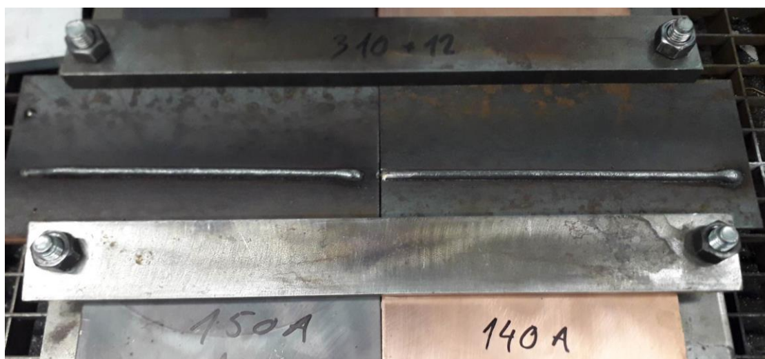
Slika 33. Očišćeni prvi slojevi spremni za navarivanje slijedećeg prolaza
