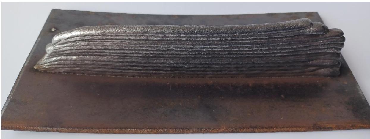
Slika 41. Ohlađen uzorak zida navaren strujom jakosti 150 A
