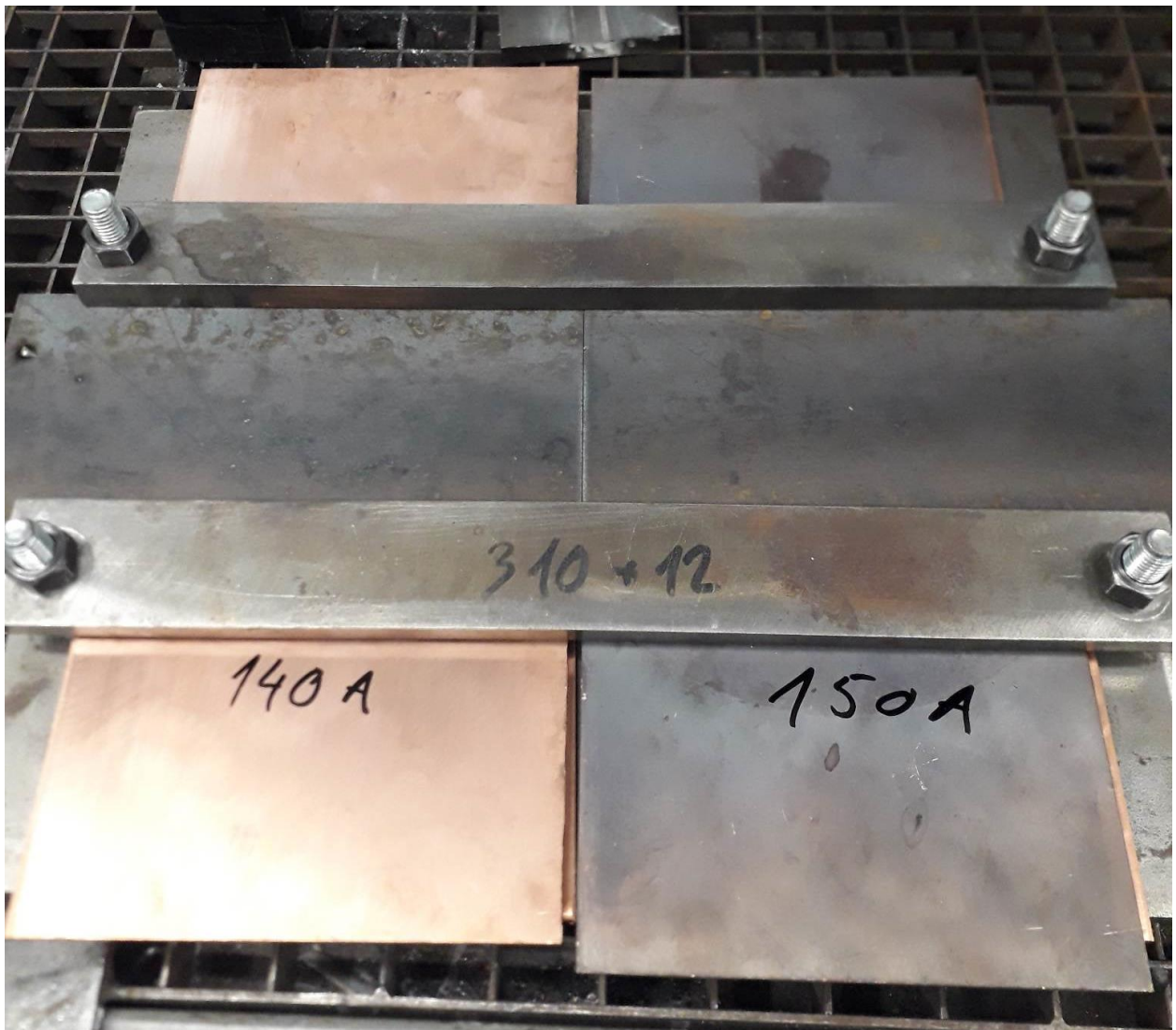
Slika 30. Pločice osnovnog materijala pričvršćene za radni stol s primjenjenim jakostima struja
