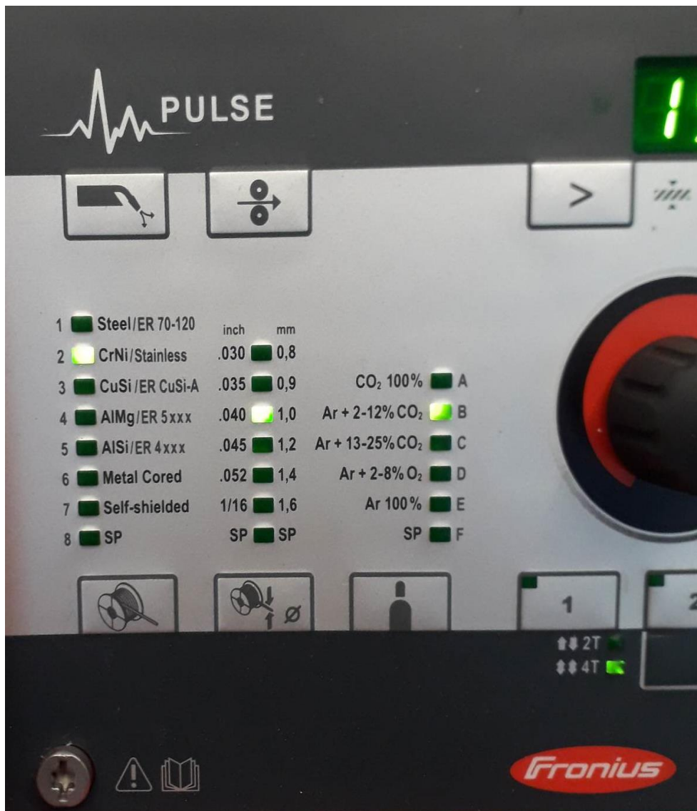
Slika 29. Izvor struje za zavarivanje s definiranim parametrima navarivanja
