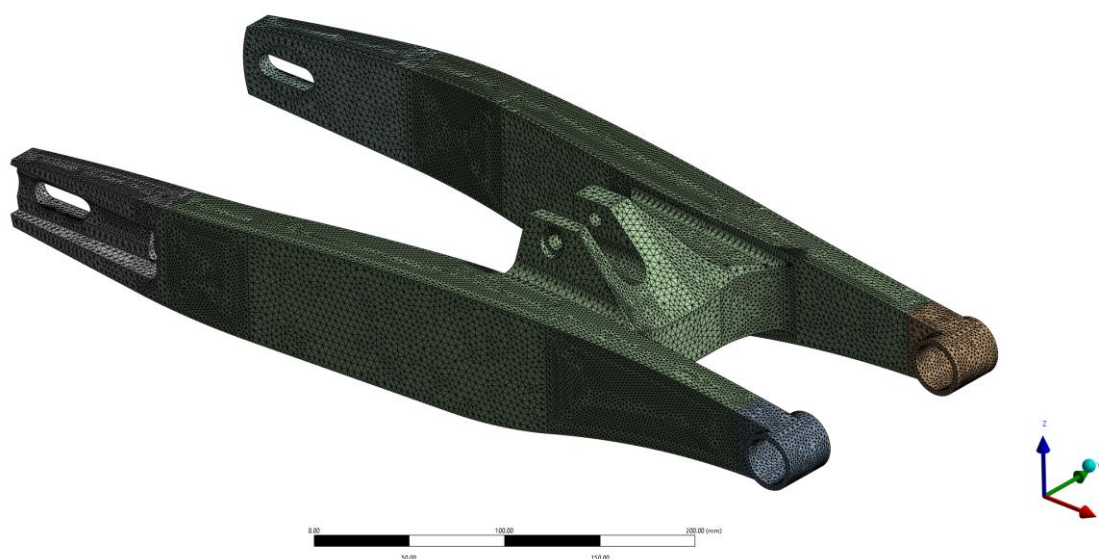
Slika 5.7 Izgled mreže modela stražnje vilice za analizu
