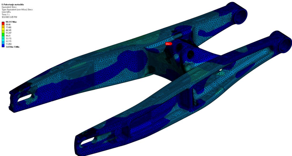
Slika 6.11 Ukupni pomak nove geometrije stražnje vilice pri pokretanju motocikla
