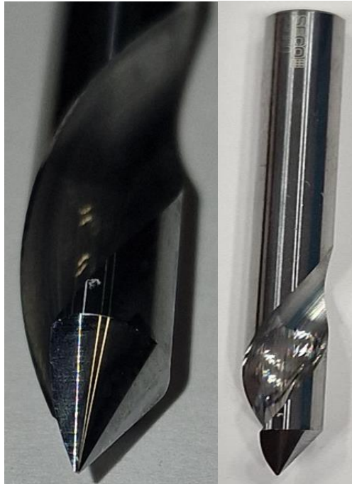
Slika 19 Glodalo za graviranje SECO 29060 [7]
