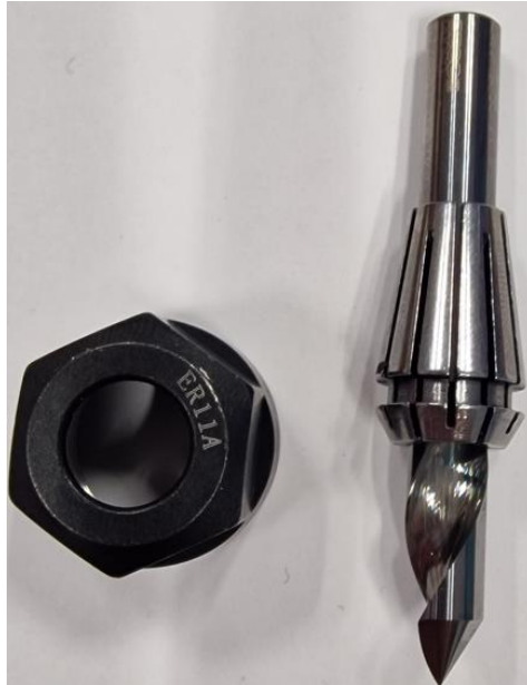
Slika 20 Glodalo za graviranje, konusna elastična čahura ER11, matica ER11A za stezanje elastične čahure [7]
