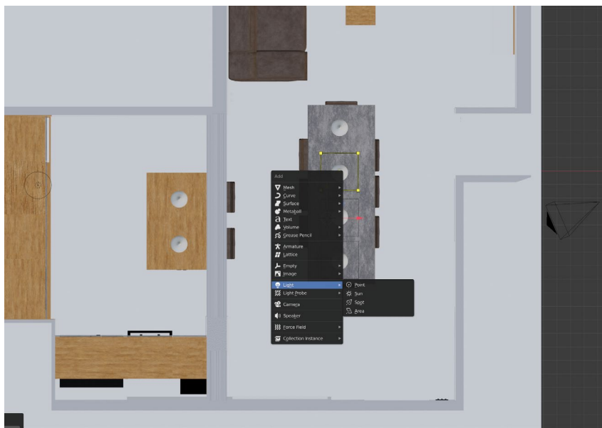
Slika 4.85: Postavljanje svijetla na rasvjetu u blagovaonici i na otoku
