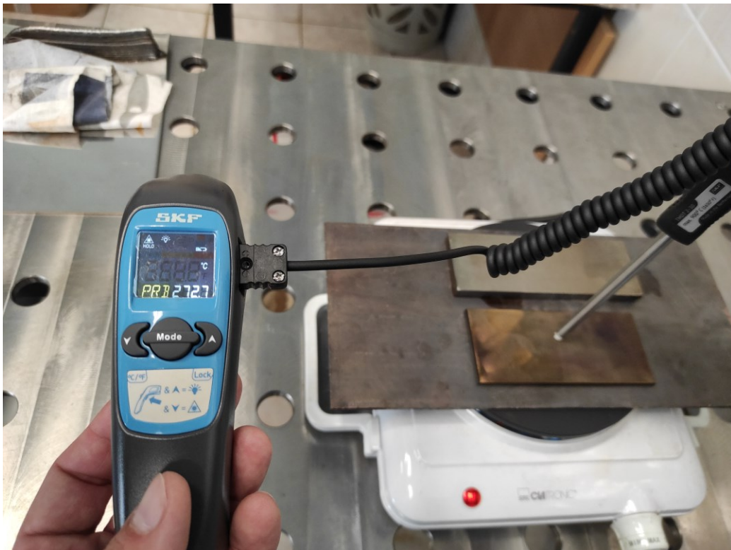
Slika 6.6. Zagrijavanje pločica na temepraturu od 300 °C
