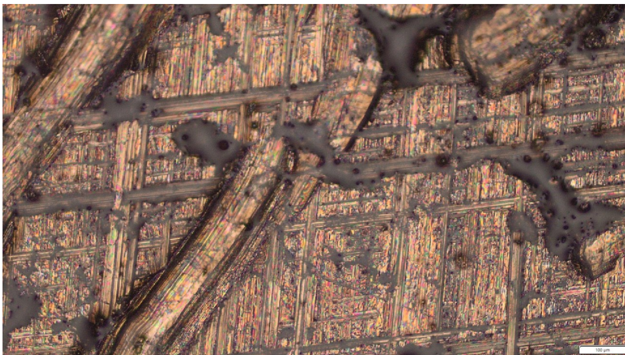
Slika 7.6. Uvećanje pločice S235JR x100 manje bruniranog mjesta na pločici
