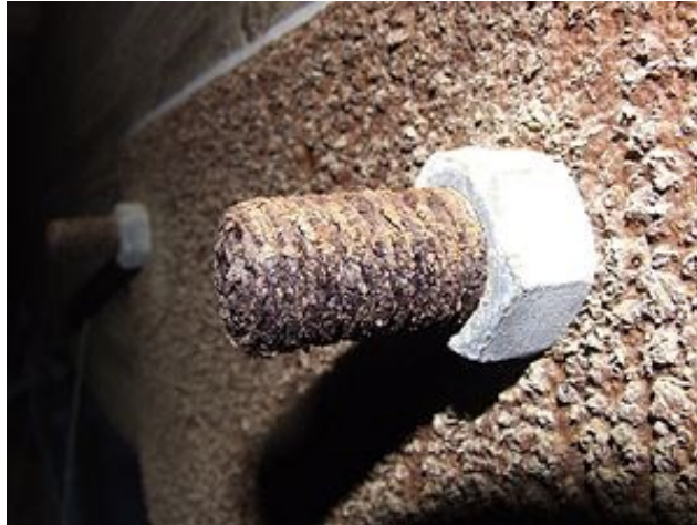
Slika 2.10. Prikaz galvanske korozije između vijka i matice [12]
