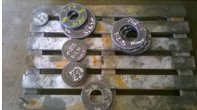
Slika 4.31: Izrezane prirubnice plazma rezačem
