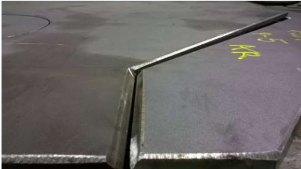
Slika 4.10: Izbrušena priprema za „x“ zavar
