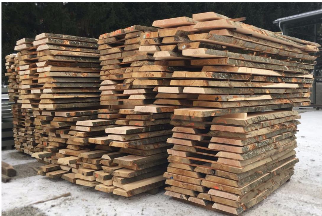
Slika 6. Prikazuje primjer razvrstavanja piljenica [16]
