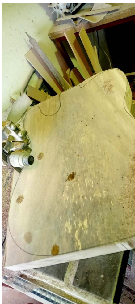
Slika 14. Prikazuje prijenos mjera iz template-a te rezanje
