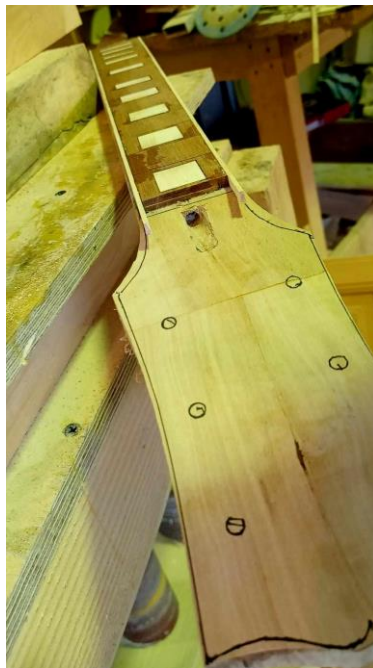
Slika 23. Vrat gitare sa truss rod-om
