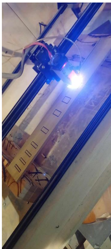
Slika 20. Izrada Template-a za vrat gitar
