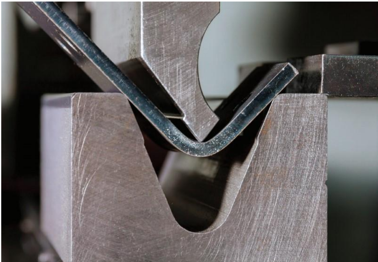
Slika 6. Prikaz alata u procesu deformacije(1)(6)
