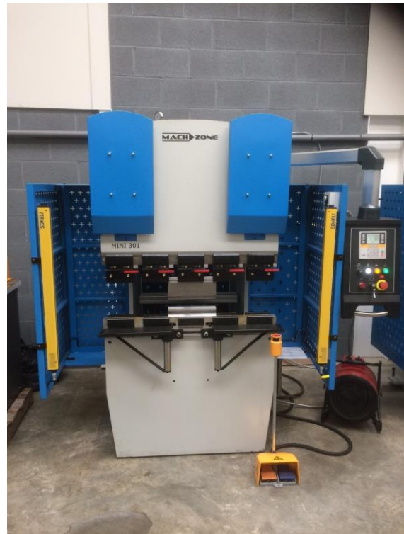
Slika 11. Prikaz preša sa pomicanjem noža(2)(2)
