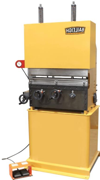
Slika 11. Prikaz preša sa pomicanjem noža(2)(2)
