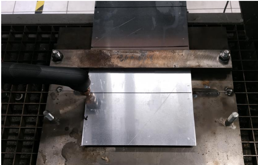
Slika 29. Plazma rezanje rezanja ispitnih uzoraka [21]
