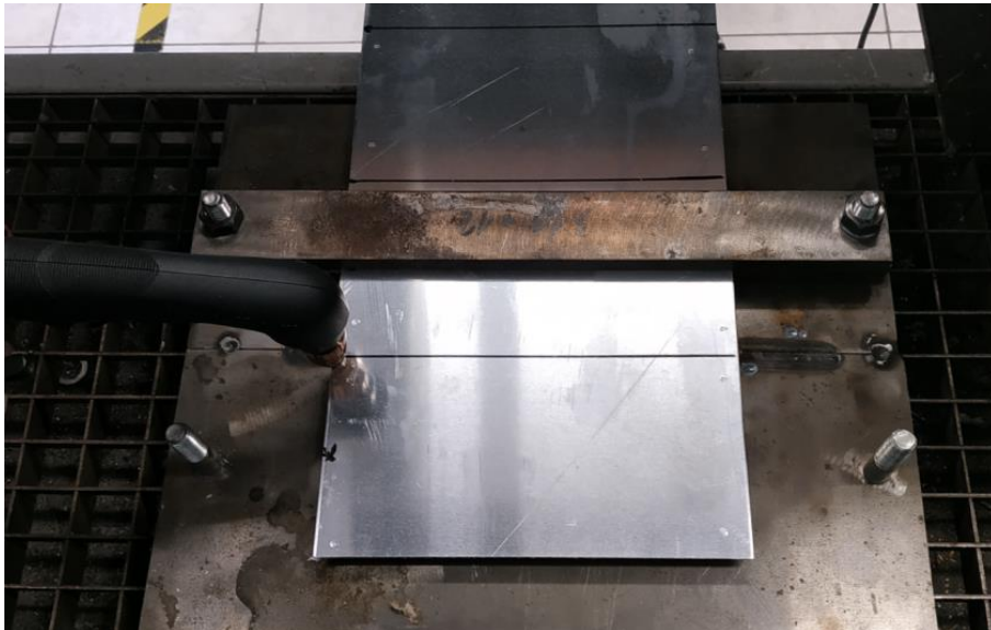
Slika 29. Plazma rezanje rezanja ispitnih uzoraka [21]
