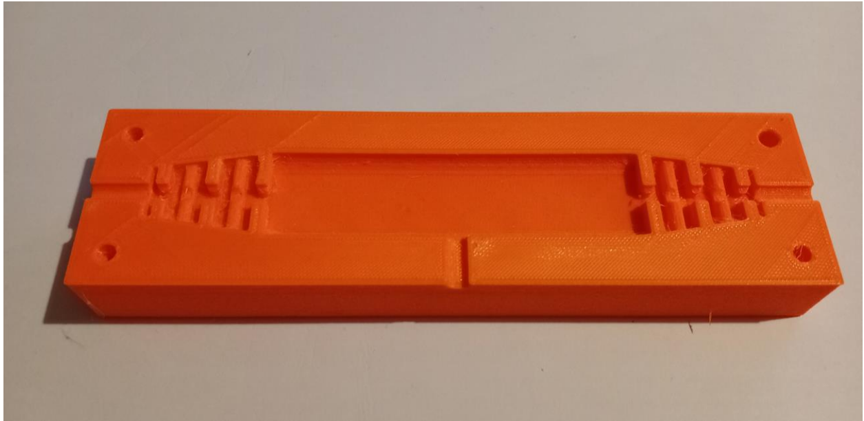
Slika 65. Prototip donjeg dijela drugog kalupa
