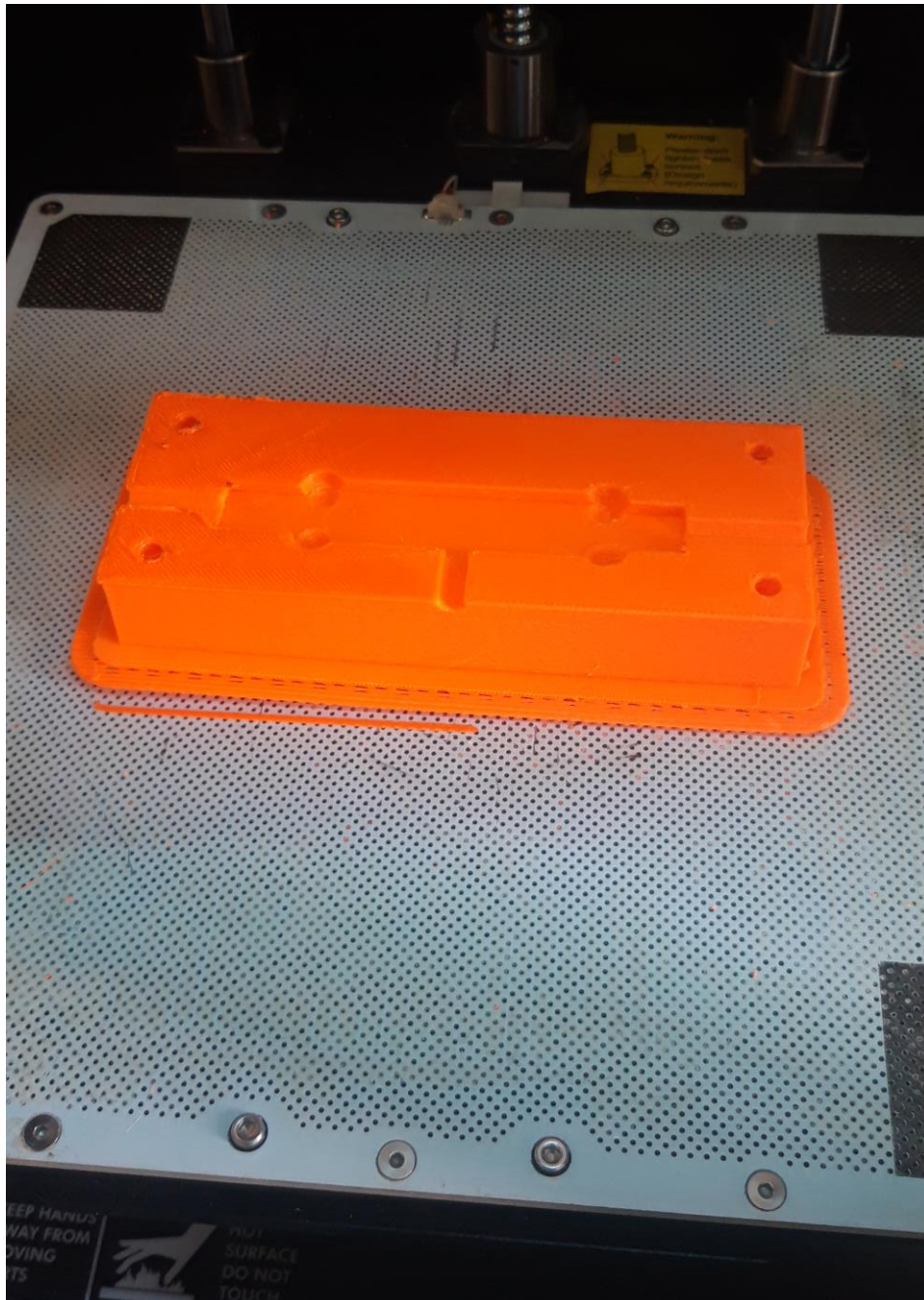
Slika 61. Prototip donjeg dijela prvog kalupa
