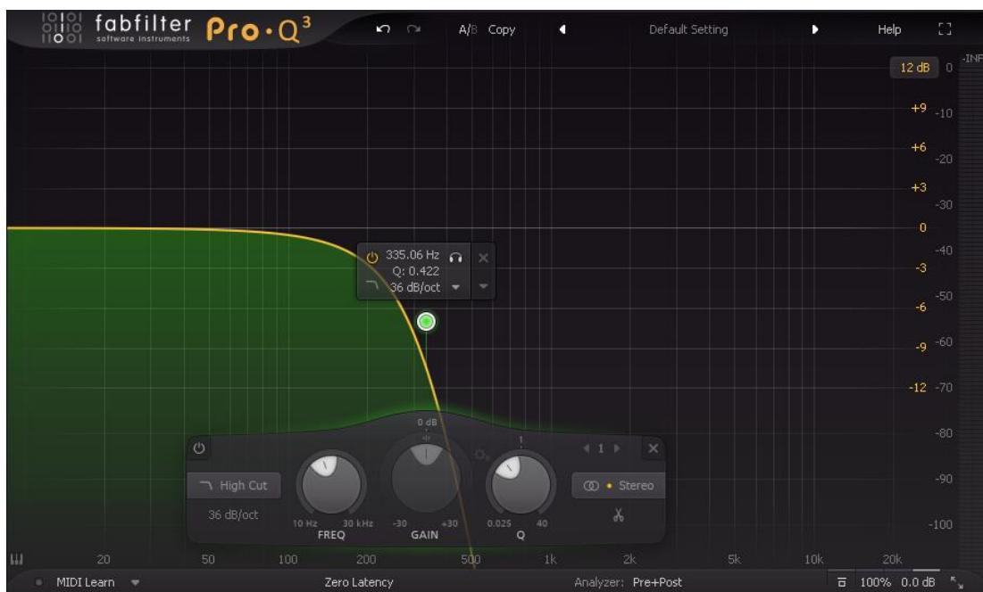
Slika 15. Fabfilter Q3 -Niskopropusni filter
