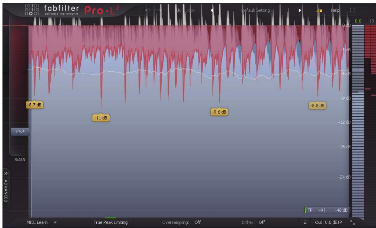
*Slika 18. Fabfilter PRO L2 – najpoznatiji digitalni limiter – 11dB limitinga vrhova na finalnom miksnu*
