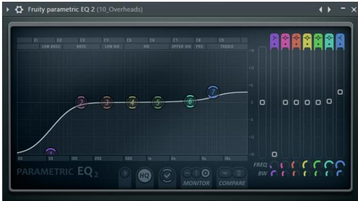
Slika 45. EQ2 primijenjen na stereo viseće mikrofone
