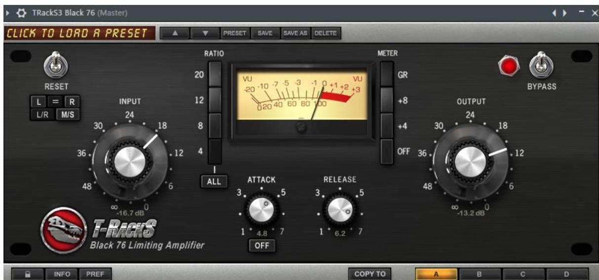
Slika 17. TrackS3 Black 76 – digitalni kompresor modeliran prema analognom kompresoru
