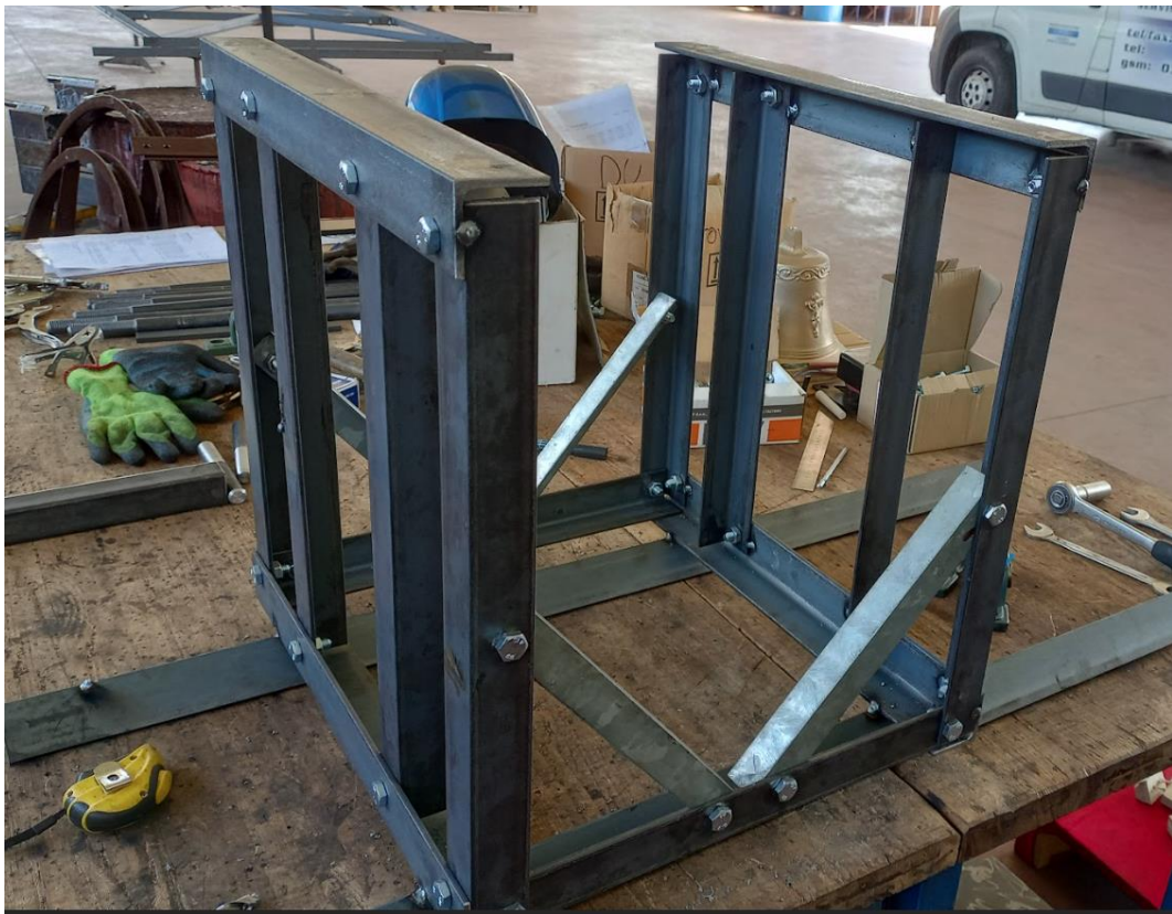
Slika 2.3.1. Izrada postolja za zvono
