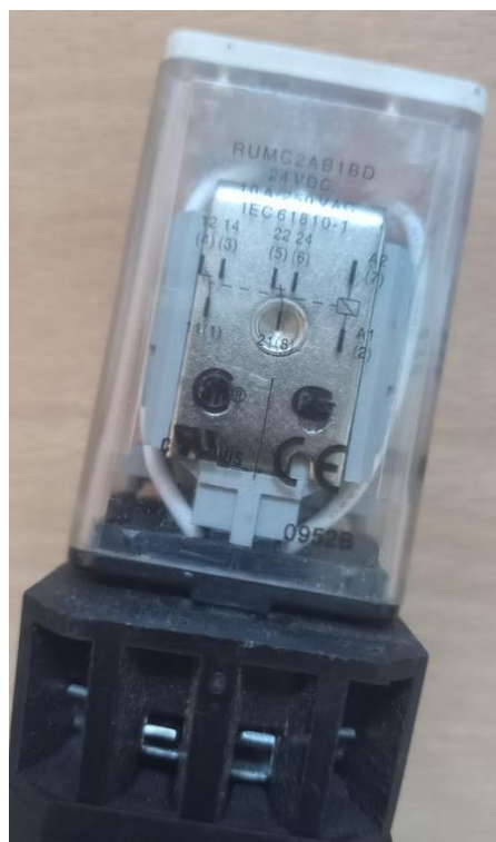
Slika 3.5.2. Shema spajanja releja otisnuta na releju
