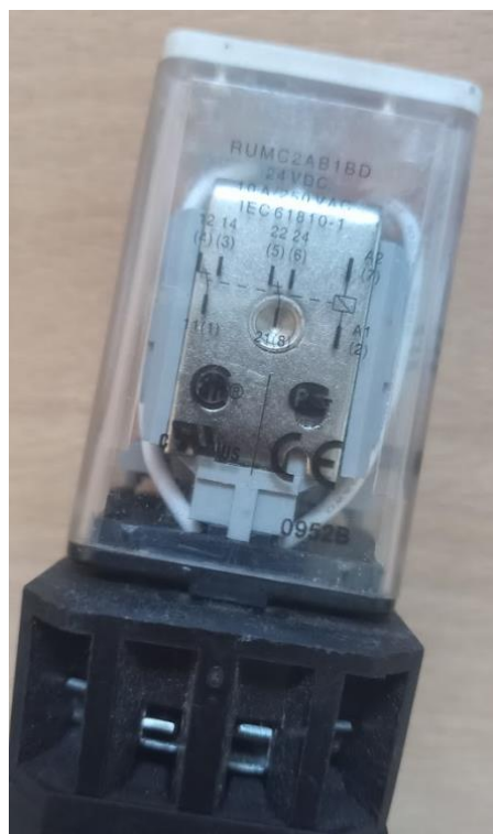
Slika 3.5.2. Shema spajanja releja otisnuta na releju
