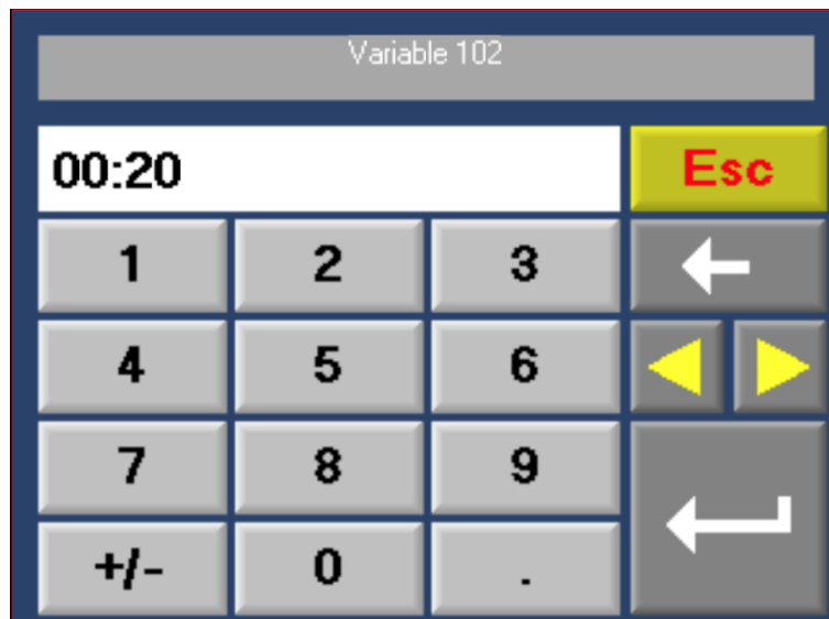
Slika 4.4.2. Postavljanje vremena trajanja zvonjenja
