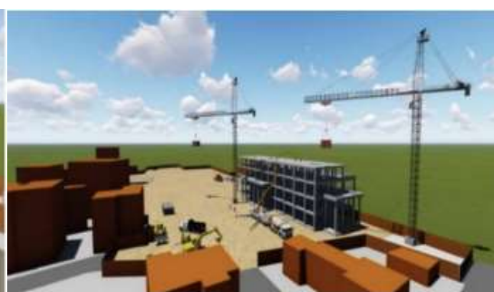
Slika 4.9 3D model scenarija 2 plana gradilišta
