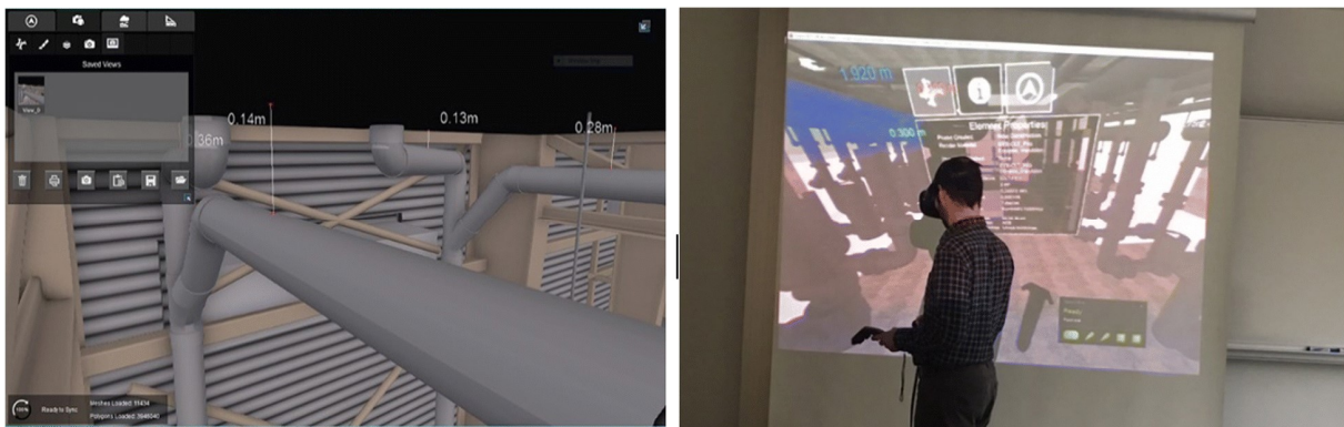
Slika 4.6 MEP sustav s dimenzijama, korisnik postavlja dimenziju pomoću HTC Vive joysticka
