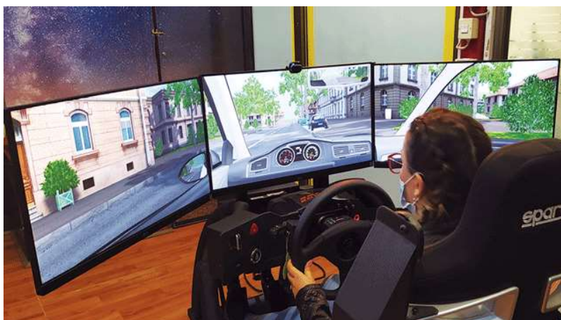
Slika 2.2 Primjer polu-imerzivnog sustava virtualne stvarnosti – vožnja automobila pomoću simulatora
