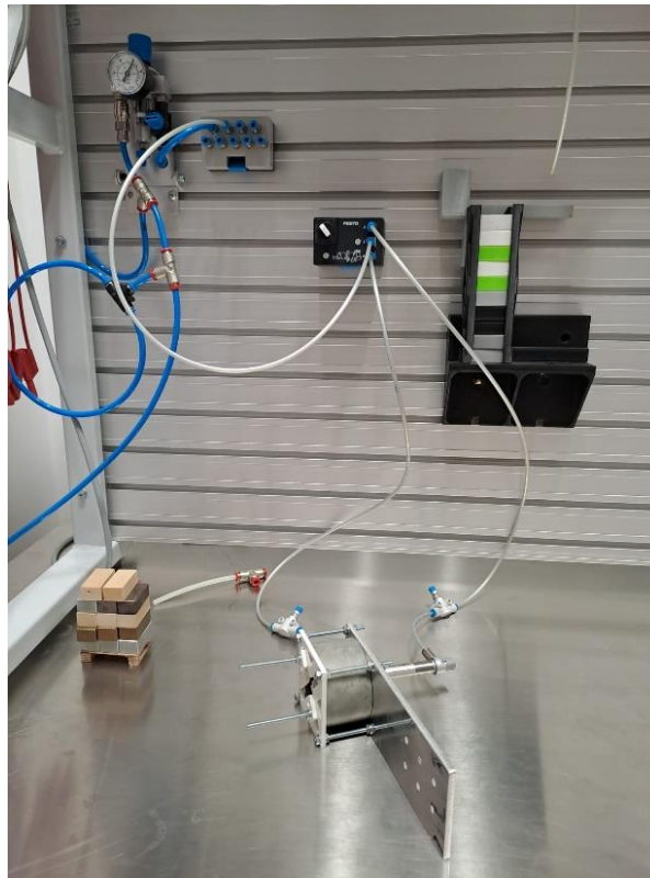
Slika 42. Test funkcionalnosti prototipa prihvatnice
