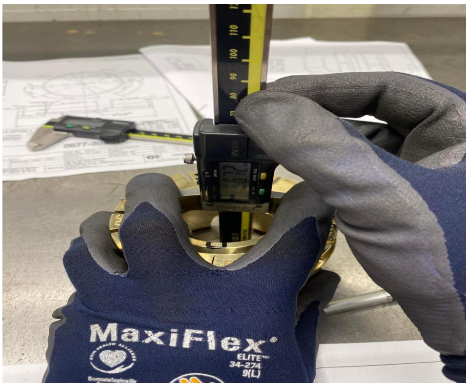
Slika 27. Mjerenje ukupne visine pomičnim mjerilom [28]
