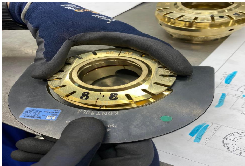
Slika 28. Mjerenje promjera prizme kalibrom [28]
