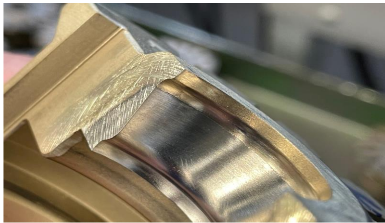
Slika 18. Primjer otpadanja metalizacije [27]
