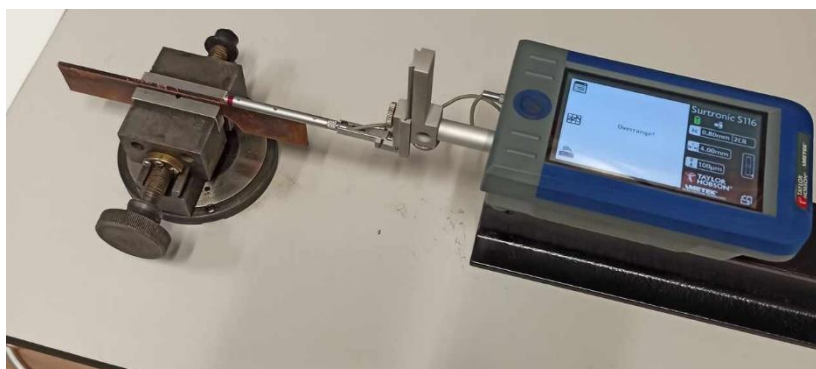
Slika 5.22. Mjerenje hrapavosti uređajem AMETEK Taylor Hobson Surtronic S [36]
