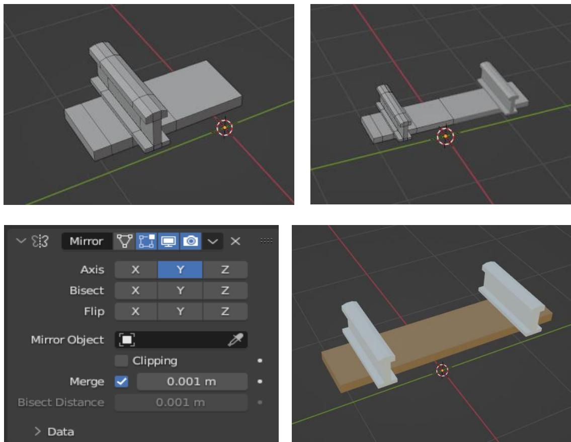
Slika 9.13 Postupak kreiranja tračnice uz korištenje modifikatora "Mirror"
