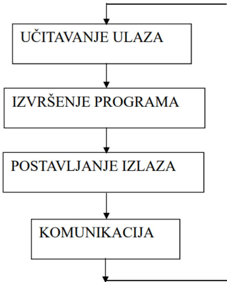
Slika 2.2. Princip rada PLC-a [4]
