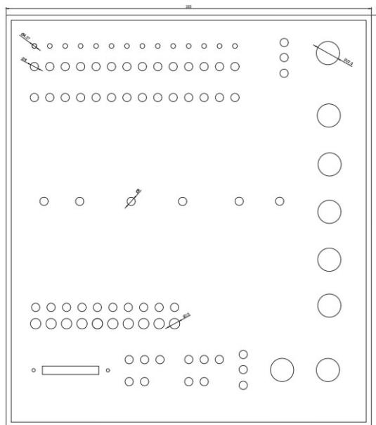
Slika 4.11 Panel 1 nacrt za bušenje
