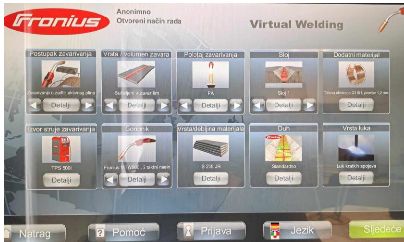
Slika 5.10 Parametri za MAG zavarivanje
