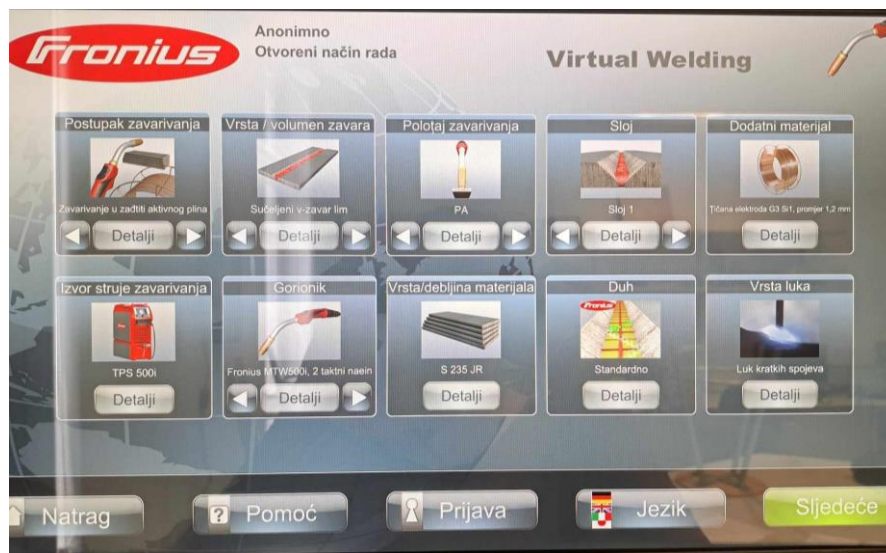
Slika 7.2. Odabrani parametri za MAG zavarivanje
