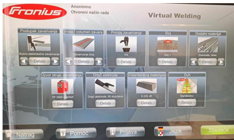
Slika 5.11. Parametri za REL zavarivanje
