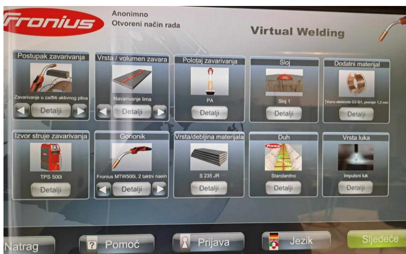
Slika 5.9 Prozor za odabir parametara virtualnog zavarivanja
