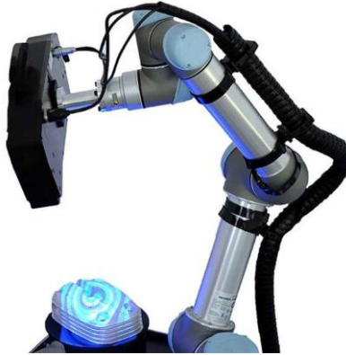
Slika 9 Robot s senzorom za 3D skeniranje [17]
