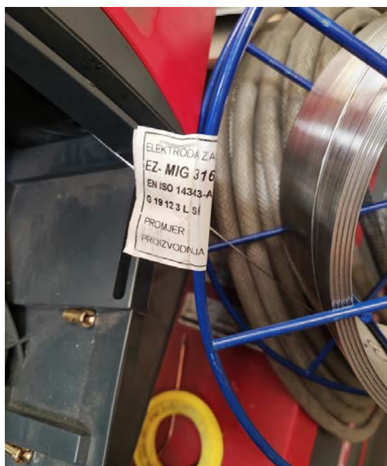
Slika 37 Elektroda za zavarivanje EZ – MIG 316 LSi [28]
