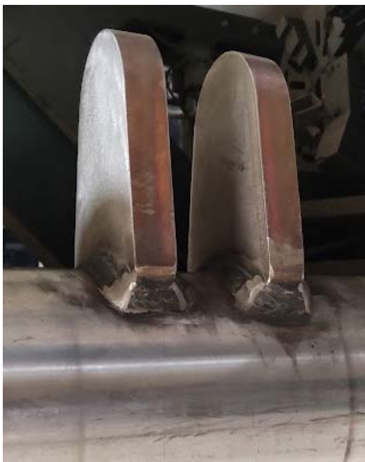
Slika 38. Kutni zavar po zatvorenoj konturi nakon čišćenja [28]
