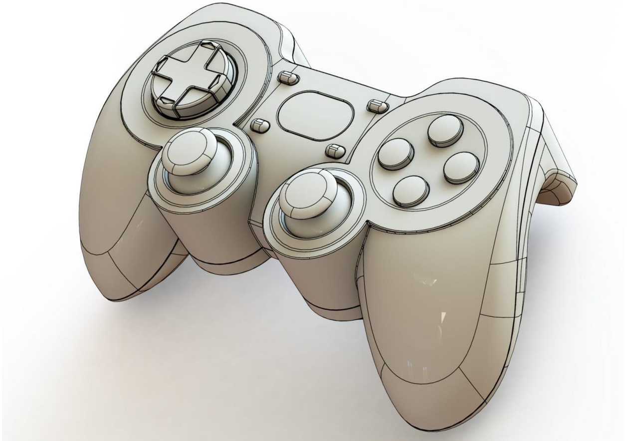
Slika 2.5 Prikaz 3D modela gaemepad-a modeliran NURBS tehnikom
