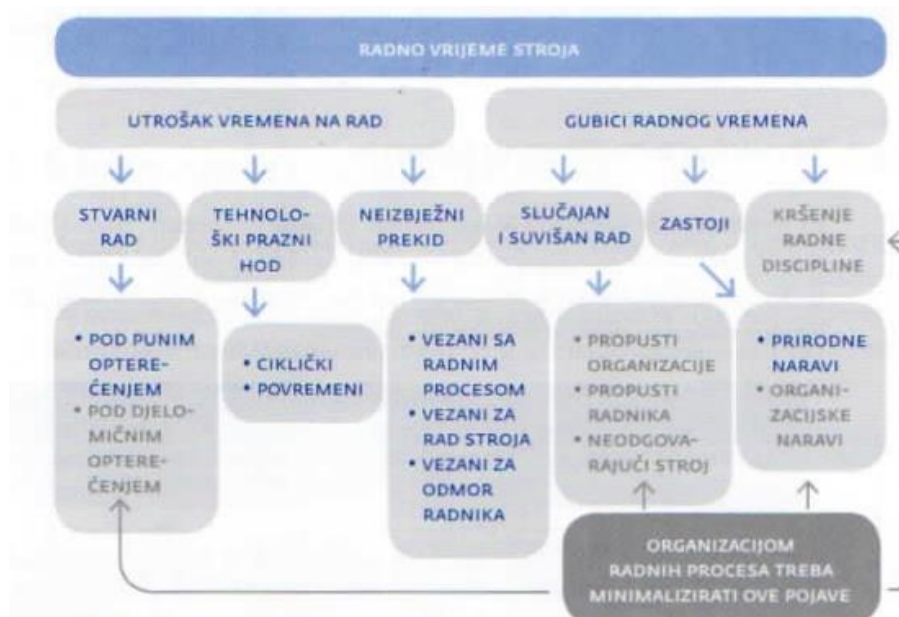
Slika 6.2. Struktura radnog vremena stroja
