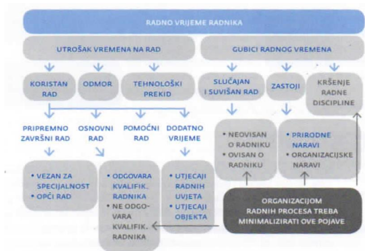
Slika 6.1. Struktura radnog vremena radnika
