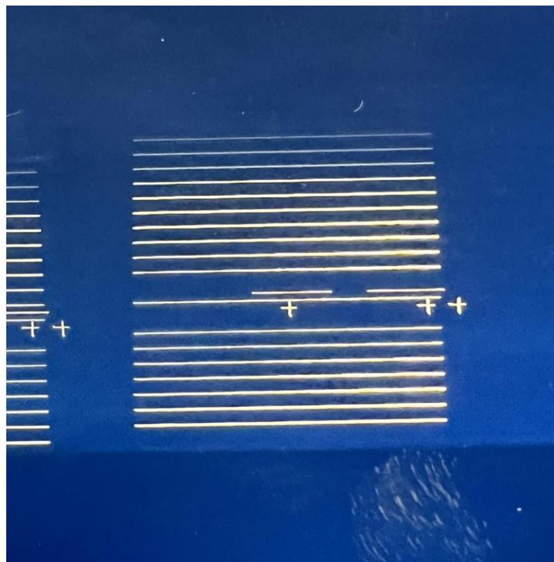
Slika 28. Fokus-test na obratku - waferu
