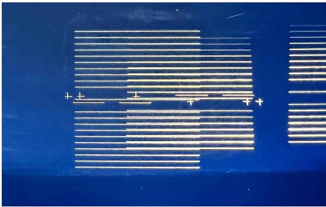
Slika 33. Fokus-test na obratku - waferu
