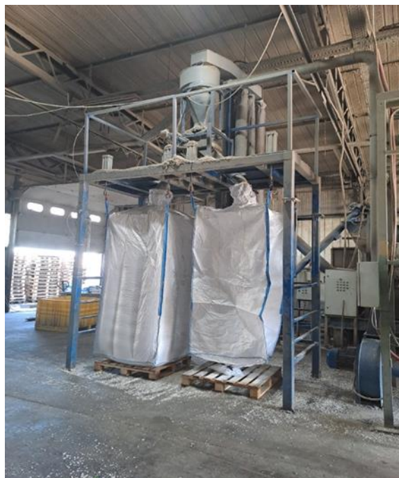
Slika 23. Stoj za pakiranje usitnjenog materijala
