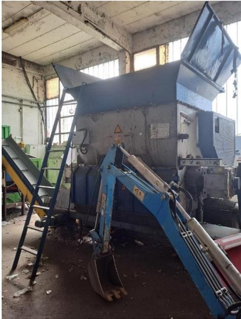
**Slika 16.** Stroj za mljevenje plastike
