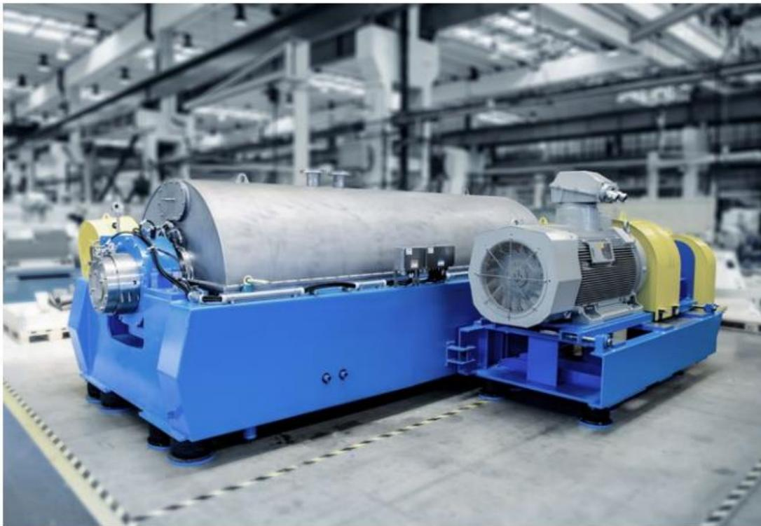
**Slika 4.** Centrifugalni stroj za recikliranje plastike [21]
