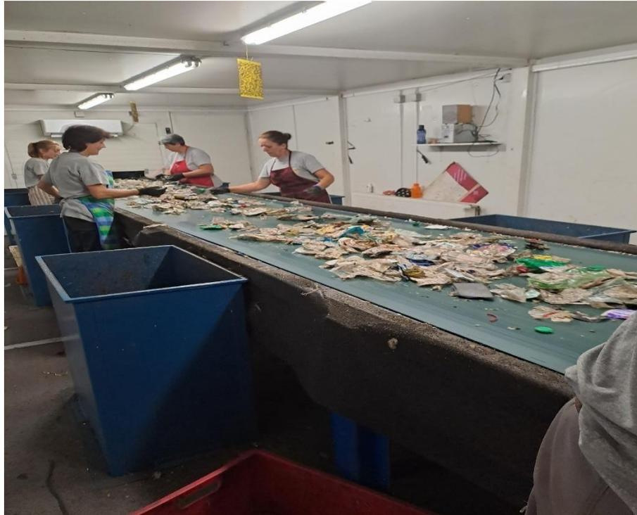
**Slika 14.** Horizontalna beskonačna transportna traka za sortiranje plastike
