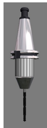
Slika 3.6 Alat za bušenje promjera 8.5 mm [2]
