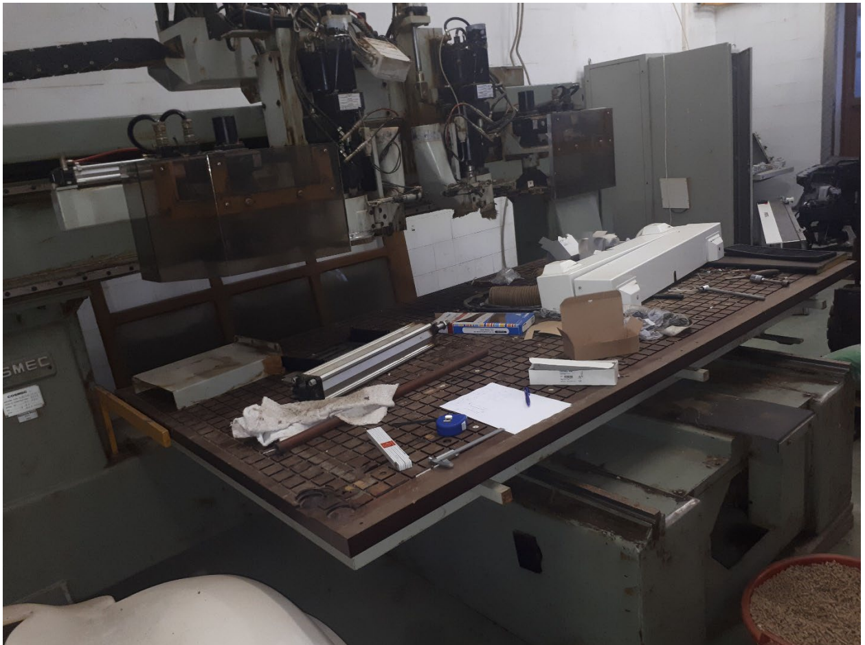
Slika 9.2 Korišteni CNC stroj Cosmec na kojeg će biti ugrađen razvijeni CNC kontroler
