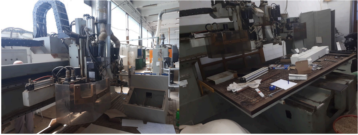
Slika 1.3 CNC vertikalna glodalica s 3 osi na koju će se implementirati razvijena upravljačka jedinica[4]
